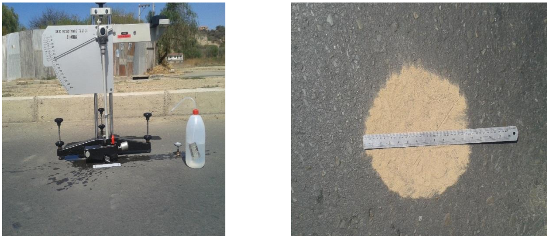
Fig. 17 Medición de la textura y C.R.D. tramo recto-Av. La Banda
