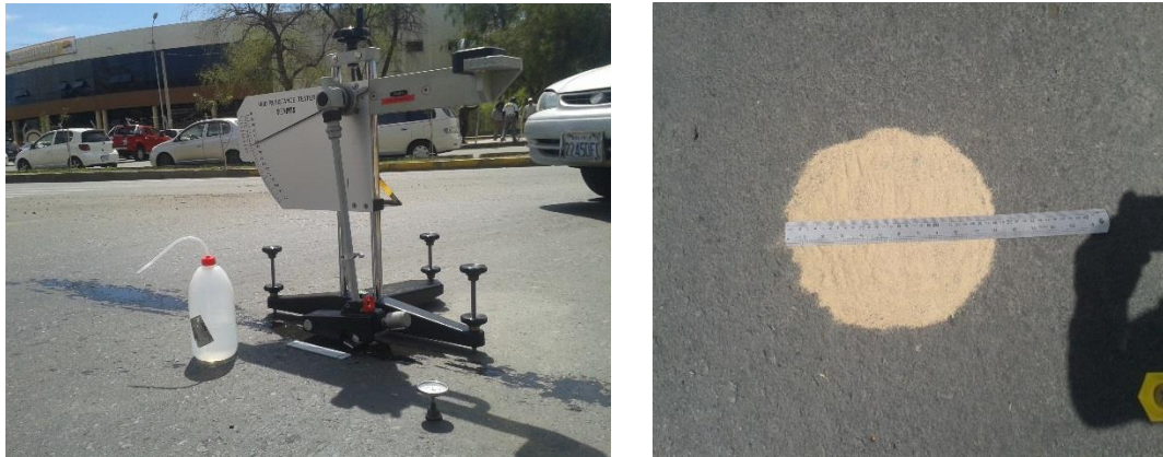
Fig. 42 Medición de la textura y C.R.D. tramo curvo-Carretera al Norte
