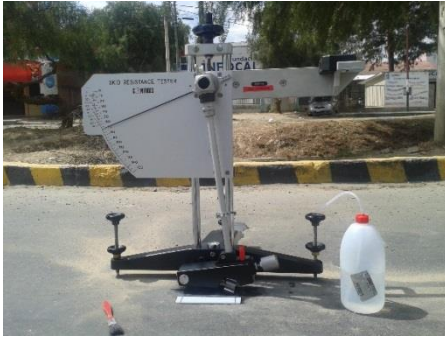
Fig. 23 Medición de la textura y C.R.D. tramo recto-Av. Las Américas
