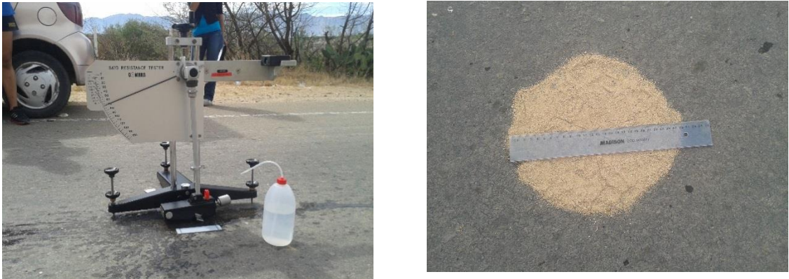
Fig. 40 Medición de la textura y C.R.D. tramo con pendiente-Carretera a Bermejo
