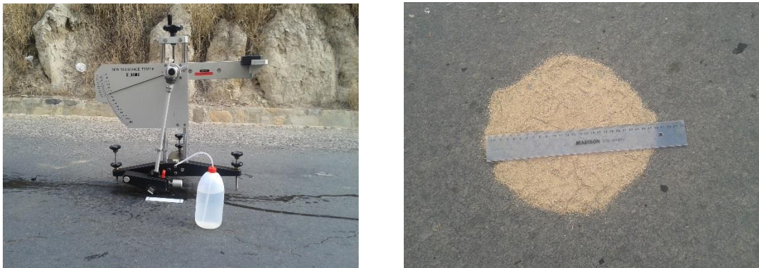
Fig. 34 Medición de la textura y C.R.D. tramo con pendiente-Carretera a San Jacinto
