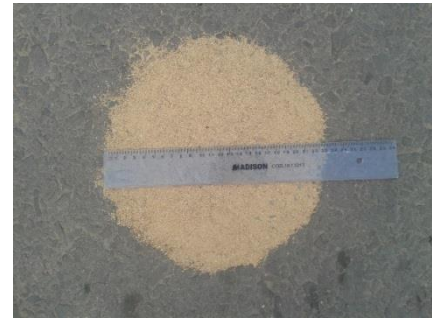
Fig. 23 Medición de la textura y C.R.D. tramo recto-Av. Las Américas
