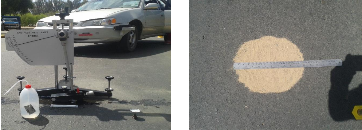
Fig. 33 Medición de la textura y C.R.D. tramo curvo-Carretera a San Jacinto
