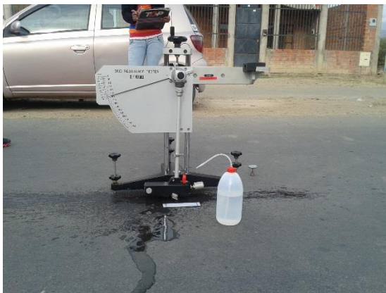
Fig. 32 Medición de la textura y C.R.D. tramo recto-Carretera a San Jacinto
