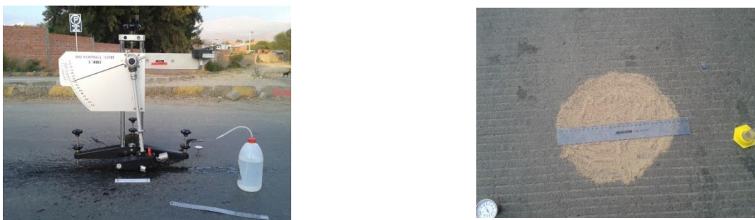
Fig. 29 Medición de la textura y C.R.D. tramo recto-Av. Circunvalación
