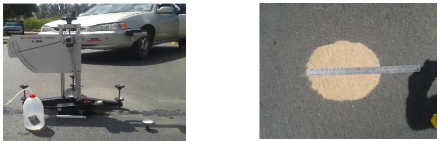
Fig. 36 Medición de la textura y C.R.D. tramo curvo-Carretera a Tolomosa
