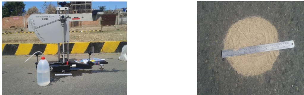
Fig. 41 Medición de la textura y C.R.D. tramo recto-Carretera al Norte
