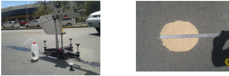
Fig. 45 Medición de la textura y C.R.D. tramo curvo-Carretera al Chaco
