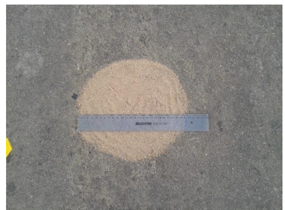
Fig. 32 Medición de la textura y C.R.D. tramo recto-Carretera a San Jacinto
