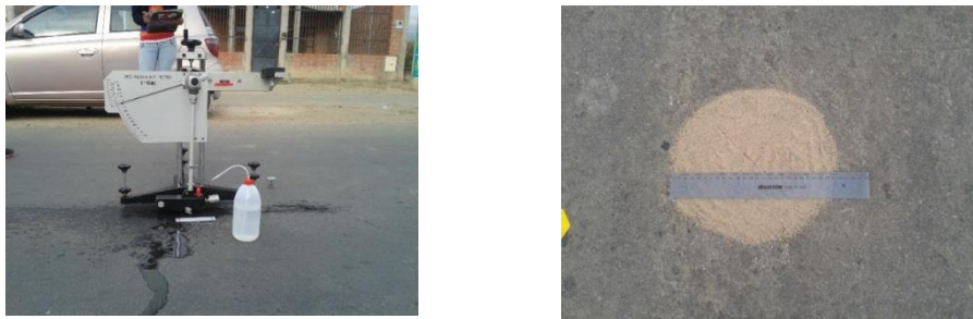
Fig. 35 Medición de la textura y C.R.D. tramo recto-Carretera a Tolomosa
