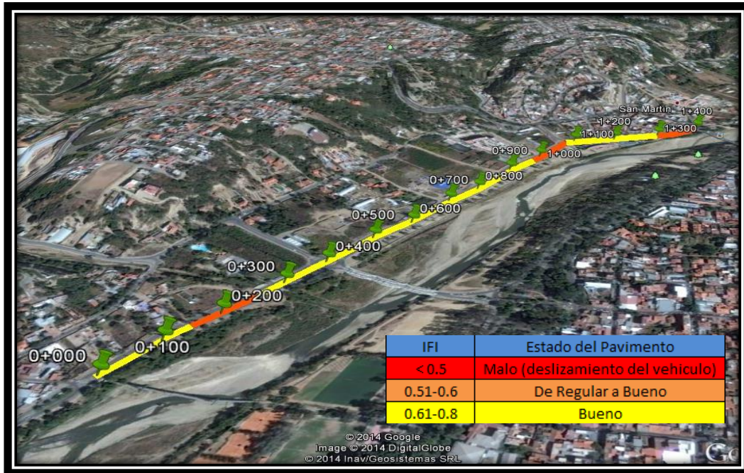
Fig.1. Estado de Pavimento Av. La Banda
