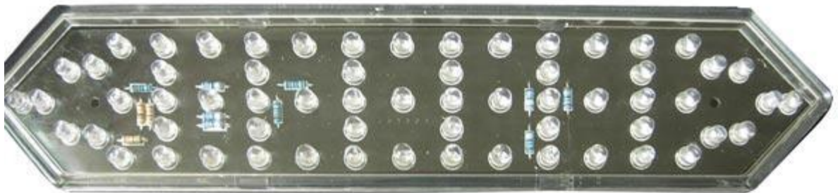
PESTAÑA DEL CONTADOR LED DE TRES COLORES (ROJO, AMARILLO Y VERDE)
