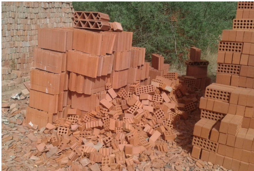
Figura 4.4: Toma de muestras de residuos cerámicos de ladrillo.
