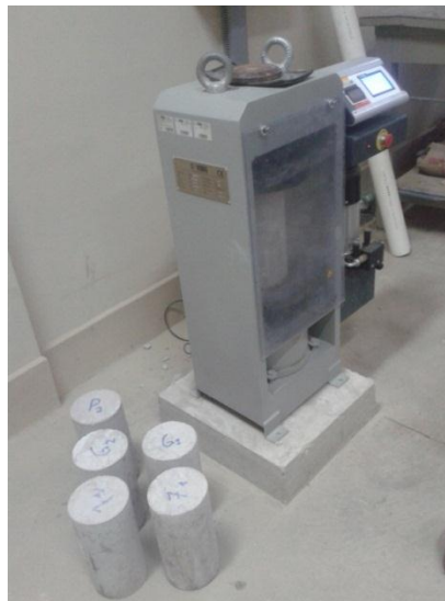
Figura 4.20: Rotura de probetas cilíndricas a compresión.
