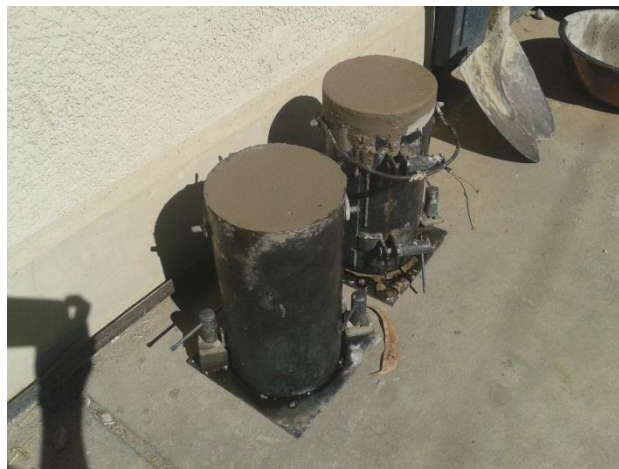
Figura 4.15: Vaciado, enrazado y fraguado de probetas de hormigón a base de residuos cerámicos de ladrillo.
