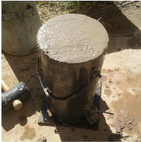
Figura 4.12: Vaciado de probetas de hormigón patrón en moldes.
