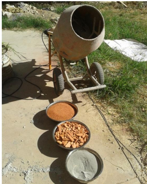
Figura 4.13: Mezcladora a punto para un hormigón al 100% de residuos cerámicos.
