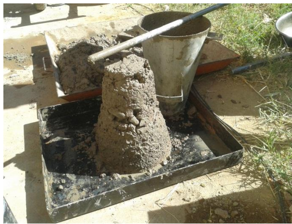
Figura 4.11: Prueba realizada con el cono de Abrams en el proceso de hormigonado.
