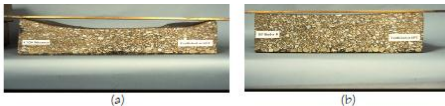
Figura 6 tipos de deformaciones según el tipo de asfaltos
