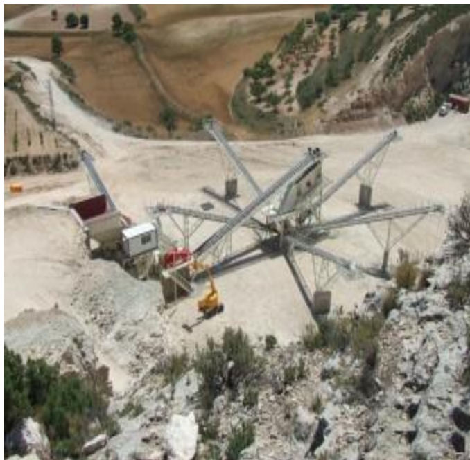
Figura 1 agregados, lavados, triturados y separados por tamaños
