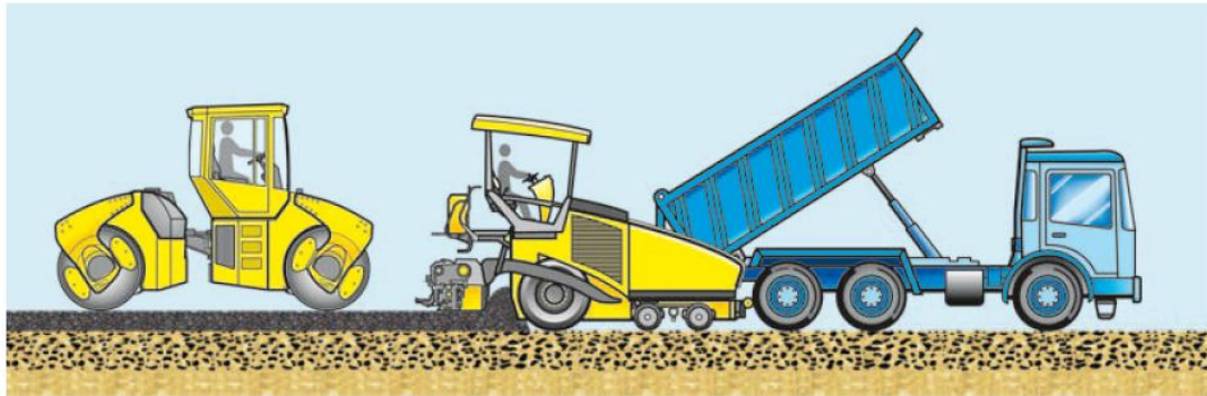
figura 10 Compactación inicial por la acabadora
