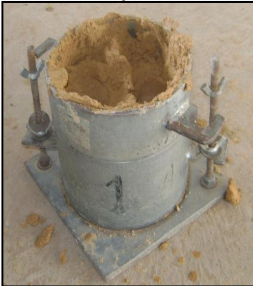
Fotografía III-28. Compactación a 5 días de saturación Prog: 17+500
