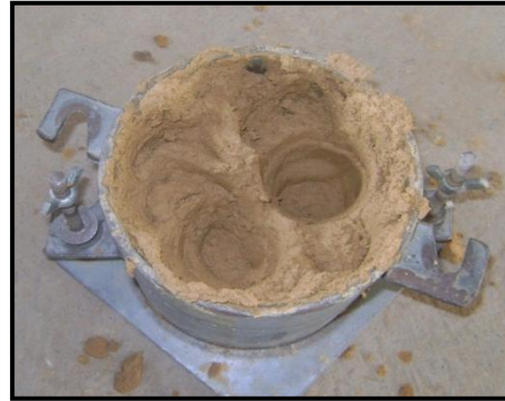
Fotografía III-33. Compactación 10 días de saturación Prog:15+500
