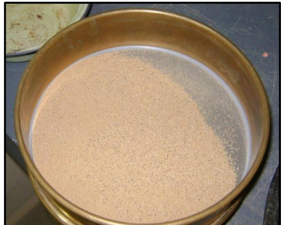
Fotografía III-12-A . Granulometría Fino Progresiva: 13+500
