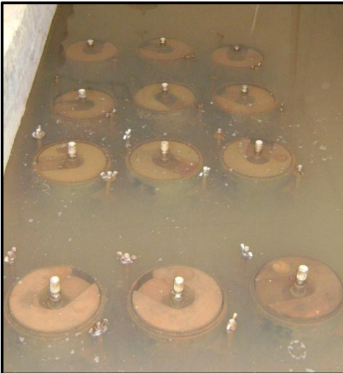
Fotografía III-24. Moldes de CBR en proceso de saturación
