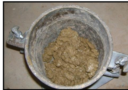
Fotografía III-35. Compactación CBR 1ra capa Prog:12+500
