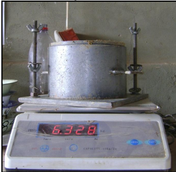
Fotografía III-29. Pesaje de Molde más Muestra Proctor Prog:18+500
