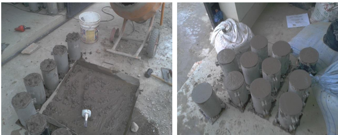
FIGURA 3.2.9-5: VACIADO Y REALIZACIÓN DE PROBETAS
