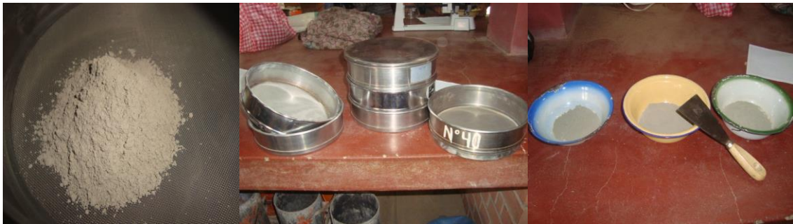
FIGURA 3.2.1-1: MATERIALES Y EQUIPO EMPLEADO PARA LA DETERMINACIÓN DE LA FINURA DEL CEMENTO
