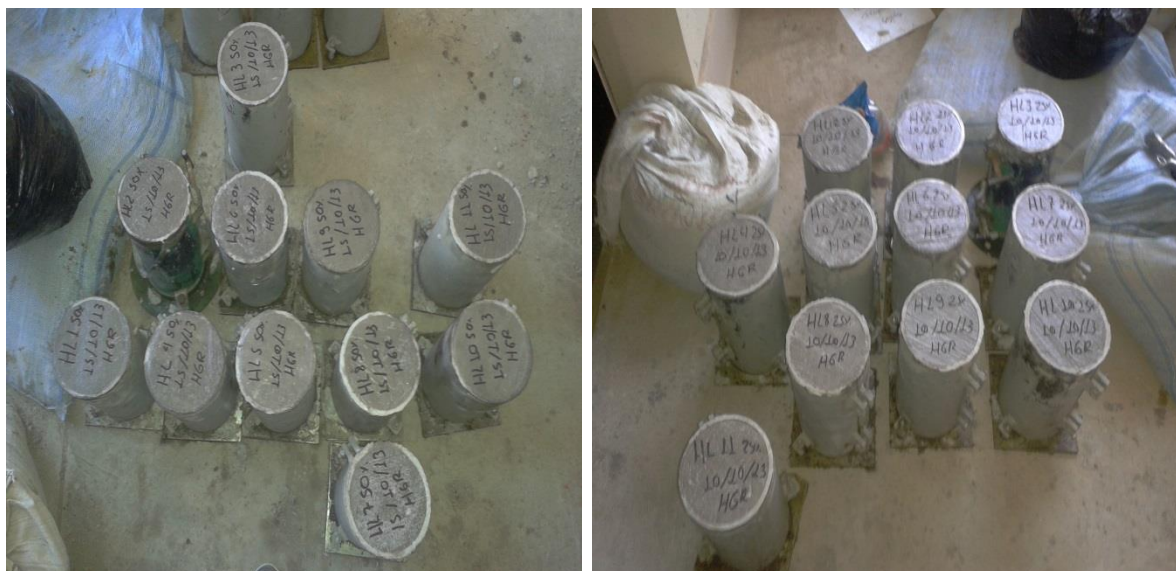
FIGURA 3.2.9-4 PROBETAS REALIZADAS Y MOLDES UTILIZADOS EN LA ELABORACIÓN DE MEZCLAS
