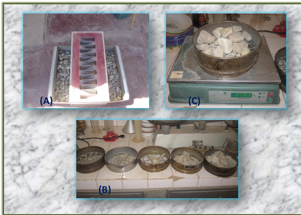
Fig. 31 (A) Cuarteo del material, (B) Granulometría de la grava, (C) Peso retenido.
