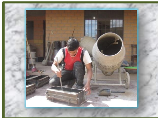
Fig. 36 Compactado de la mezcla de hormigón en molde rectangular “viga”
