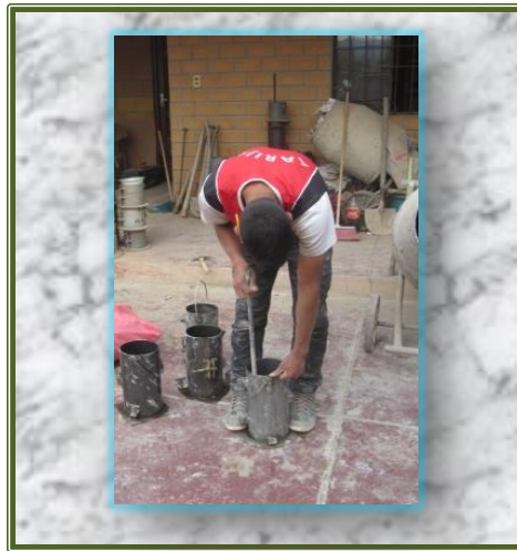
Fig. 35 Compactado de la mezcla de hormigón en molde cilíndrico
