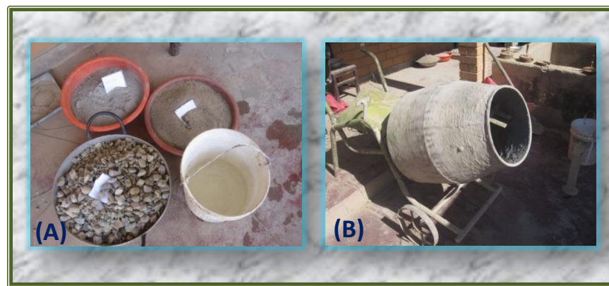
Fig. 33 (A) Proporciones de mezcla, (B) mezcladora giratoria eléctrica.
