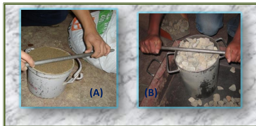
Fig. 32 (A) PU. Enrazado de Arena, (B) PU. Enrazado de Grava.
