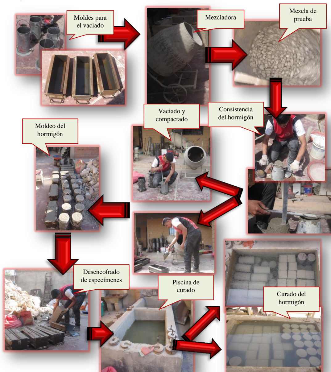
Fig. 30. Moldeado de especímenes. Fuente: Elaboración propia
