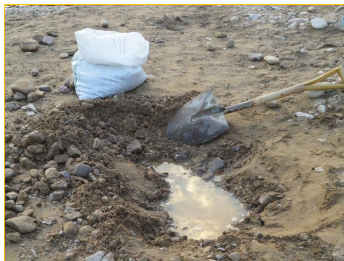
Figura 4. 6 Extracción de muestra de la parte convexa del río de un punto de la rejilla.
