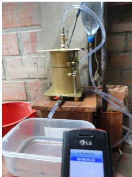
Figura 4. 10 Prueba de permeabilidad para carga constante.
