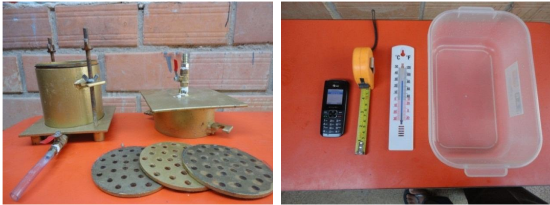
Figura 4. 9 Equipo y materiales para el ensayo de permeabilidad.
