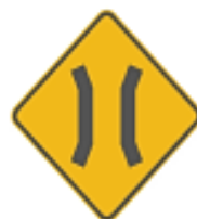
SP-44 PUENTE ANGOSTO
