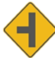
SP-19 VÍA LATERAL IZQUIERDA
