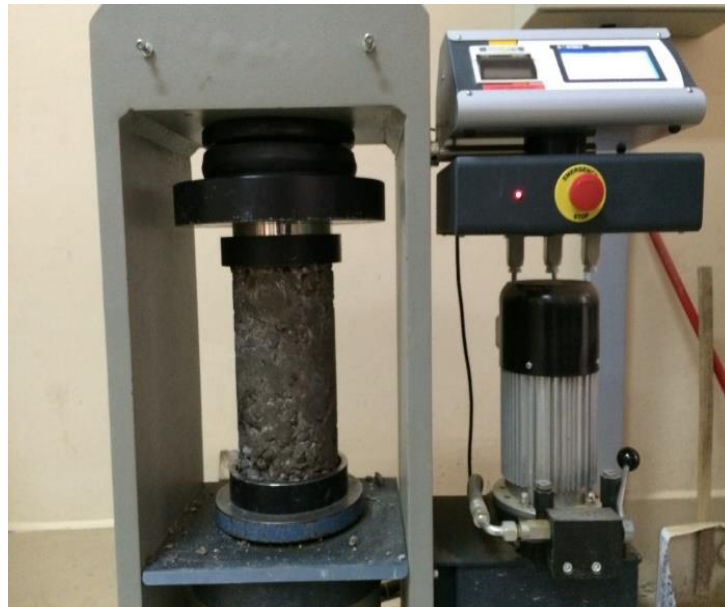
Figura 3. 13 Ruptura de probeta utilizando los retenedores con base de Neopreno
