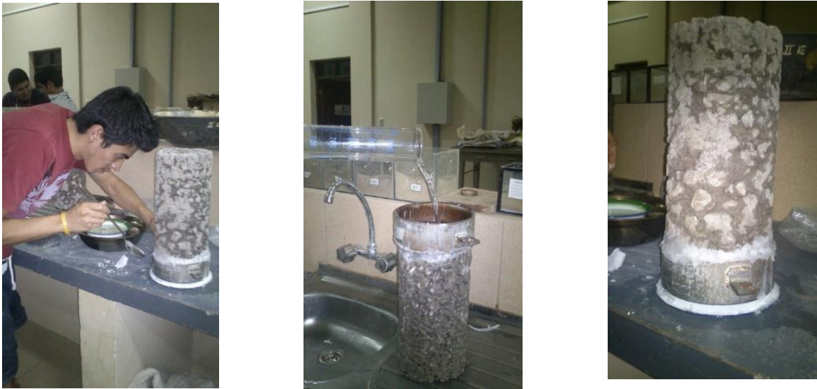
Figura 3. 14 Ensayo para la determinación de la tasa de infiltración
