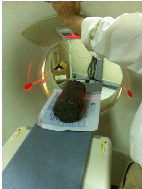
Figura 3. 7 Pruebas de tomografía computarizada aplicando Rayos X sobre las Probetas de Hormigón Poroso
