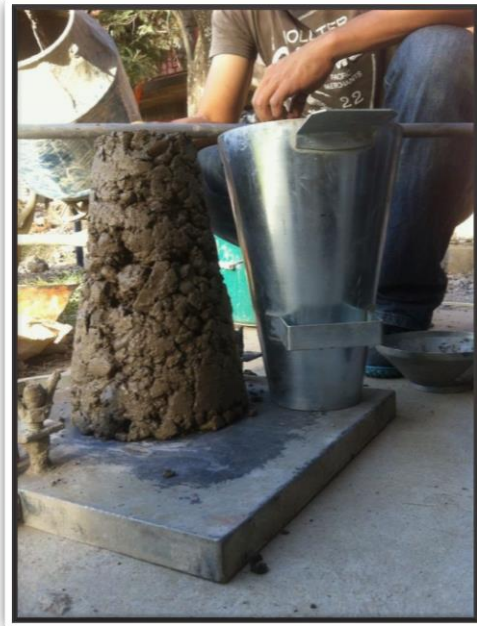
Figura 3. 4 Ensayo de consistencia sobre la mezcla dosificada con 15% de vacíos
