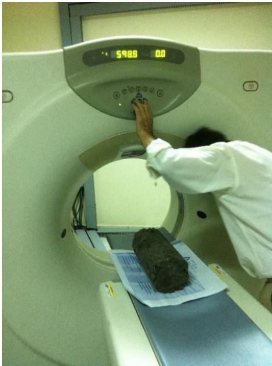
Figura 3. 7 Pruebas de tomografía computarizada aplicando Rayos X sobre las Probetas de Hormigón Poroso
