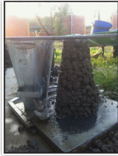
Figura 3. 5 Ensayo de consistencia sobre la mezcla dosificada con 20% de vacíos
