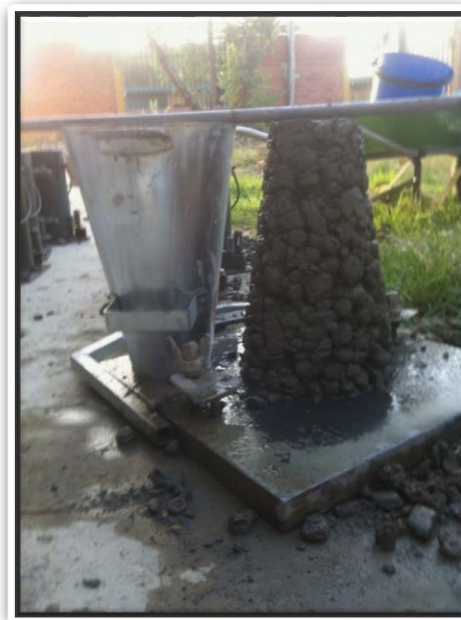
Figura 3. 6 Ensayo de consistencia sobre la mezcla dosificada con 25% de vacíos
