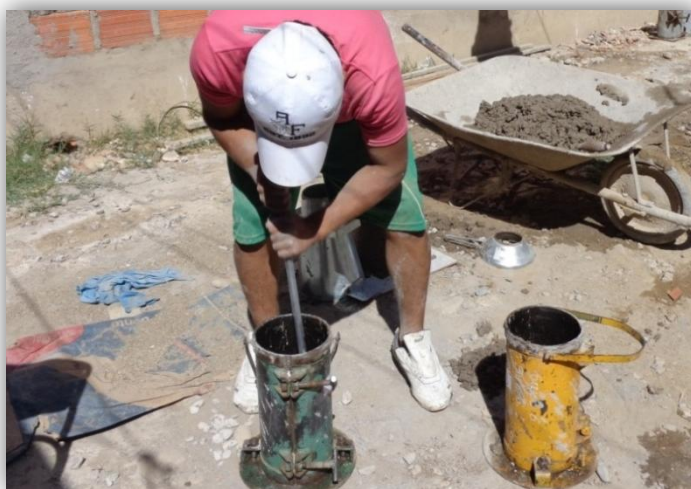
Varillado del hormigón 25 golpes por capa
