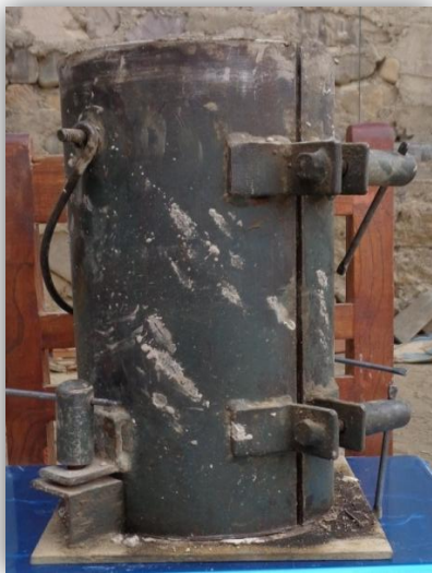
Molde cilíndrico de 15 cm de diámetro y 30 cm de altura Cono de habrams
