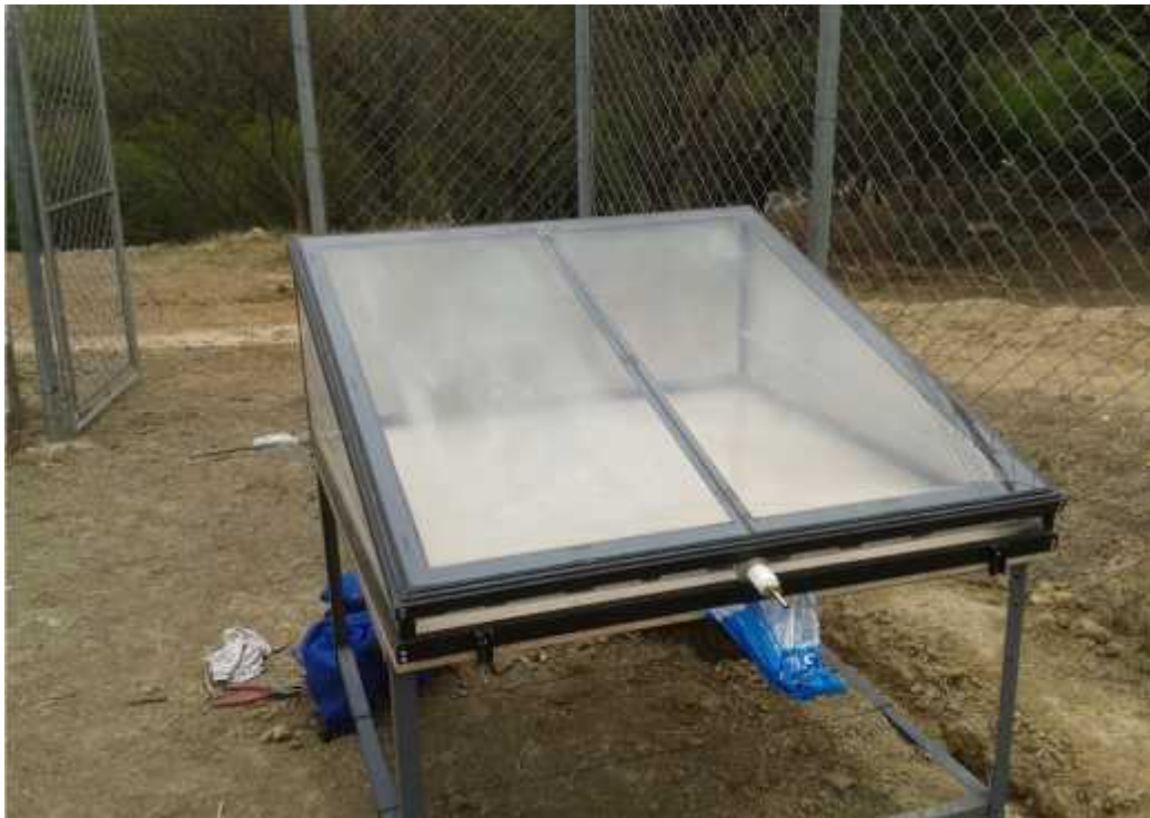
Foto 4.5. Módulo de acrílico instalado
