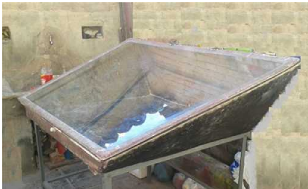
Foto 4.6.- Módulo de fibra de vidrio terminado
