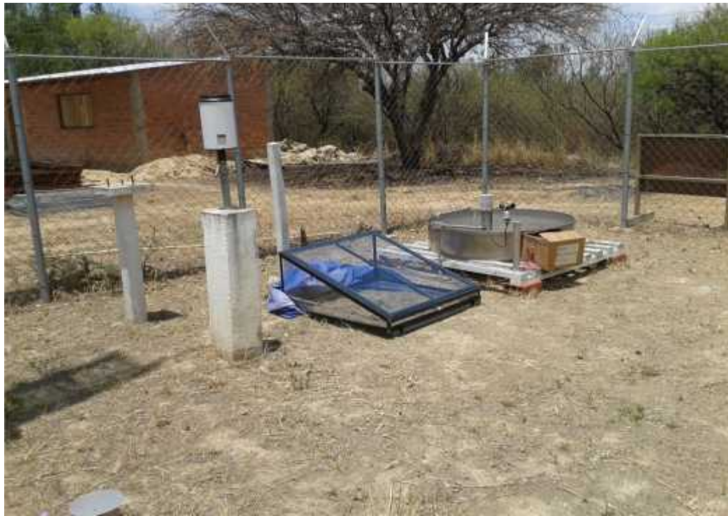
Foto 4.3.- Módulo de acrílico preparado para la instalación
