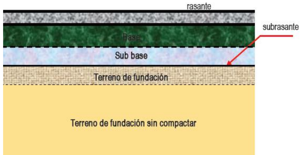
Figura 2: Estructura Típica De Pavimentos Asfálticos
