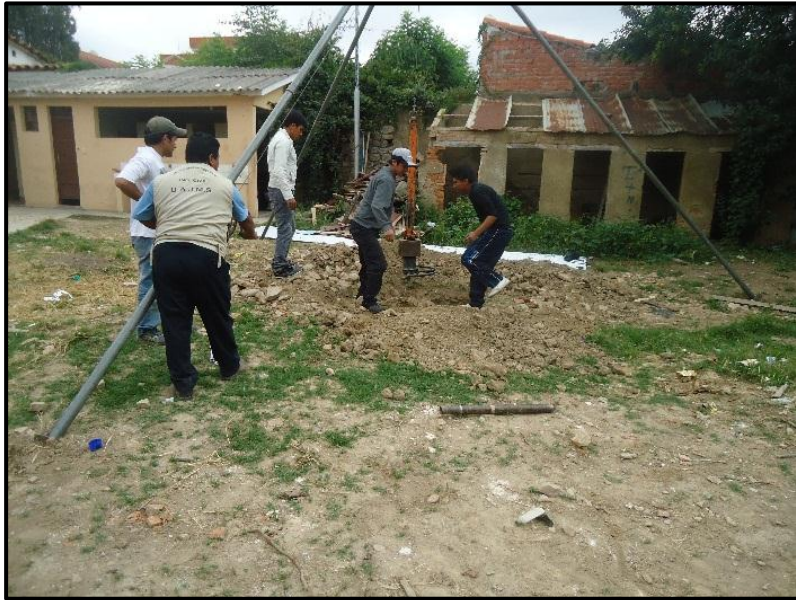
Ilustración 1: Equipo Ensayo SPT, Elaboración Propia
