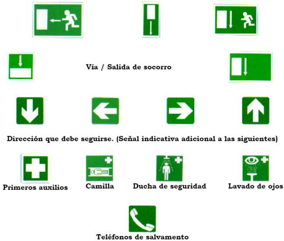
Ilustración 35; Señales Informativas, Dirección General de Protección Civil y Emergencias, Gobierno de España
