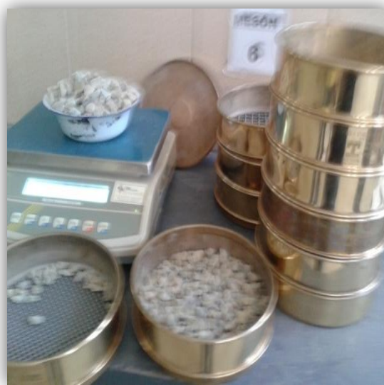
Figura-3.33– Pesando el Material tamizado Fuente: Elaboración propia
