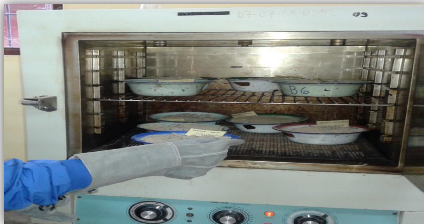
Figura- 3.53 –Muestra en el horno a una T 30°C Fuente: Elaboración Propia
