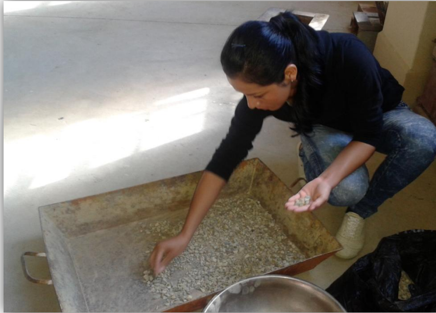
Figura-3.7- Separando las partículas fracturadas y no fracturadas
