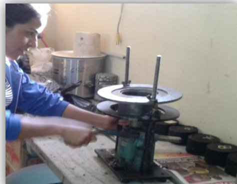
Figura-3.61– Desmolde de la briqueta Fuente: Elaboración Propia
