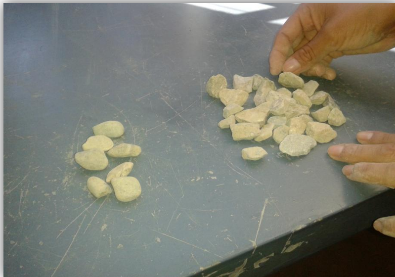
Figura- 3.8- Inspección y detección de las partículas fracturadas.
