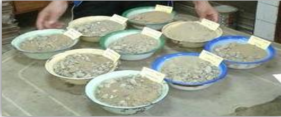
Figura-3.52- Bandejas separadas para cada briqueta la cantidad necesaria Fuente: Elaboración Propia
