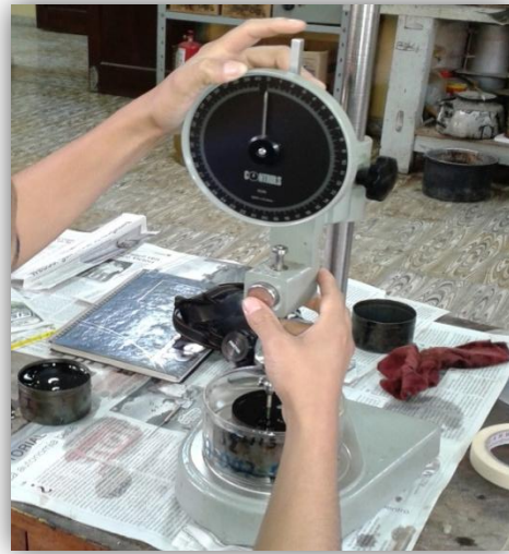
Figura- 3.35– Lectura de penetración 25 °C, 5 segundos y con un peso de 100 g Fuente: Elaboración propia
