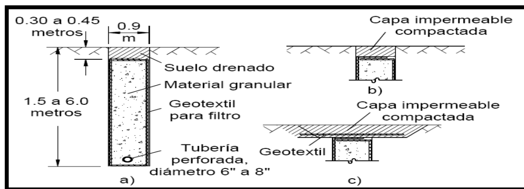
Figura 3.4.1.1 Detalles típicos de una zanja drenante
