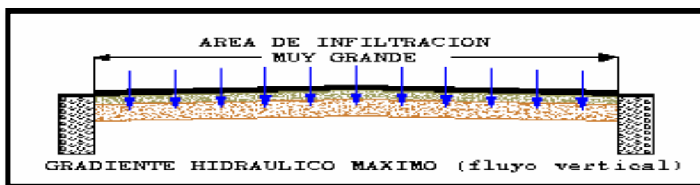
Figura 3.2.4.2 Infiltraciones a través de la carpeta
