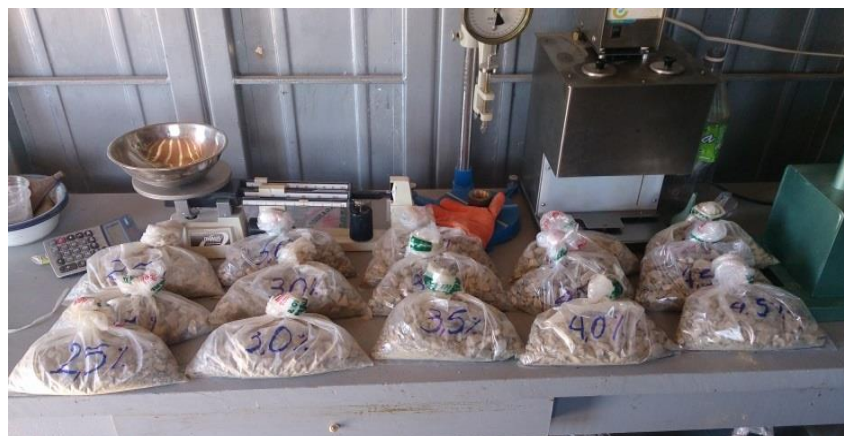
Figura 4.11 Paquetes de 1200 g. de mezcla de agregado para briquetas de mezcla modificada
