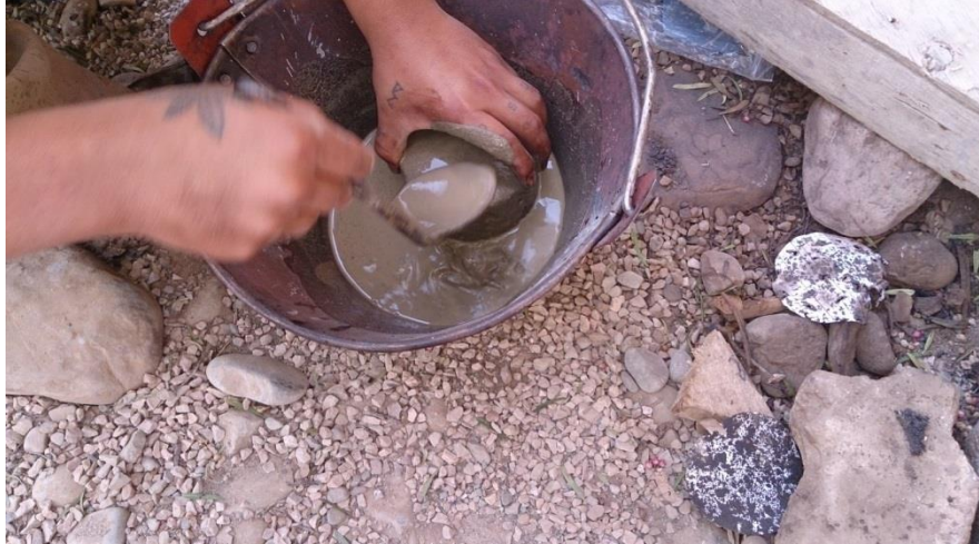
Figura 4.15 Vertimiento de la lechada de cemento en las briquetas
