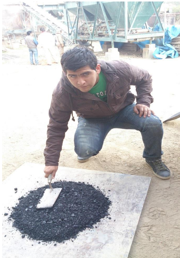
Figura 4.7 Preparación de la mezcla asfáltica a 140 °C
