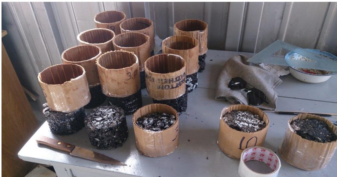
Figura 4.14 Encofrado de las briquetas sin agregado fino para el vertimiento de la lechada
