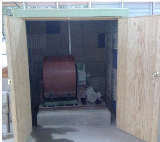
Figura 2.6 Maquina de desgaste de Los Ángeles
