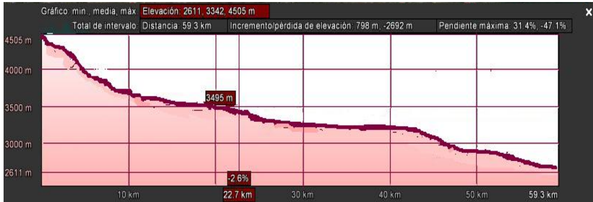
FIGURA N° 3.2: PERFIL LONGITUDINAL DEL RÍO TOMAYAPO
