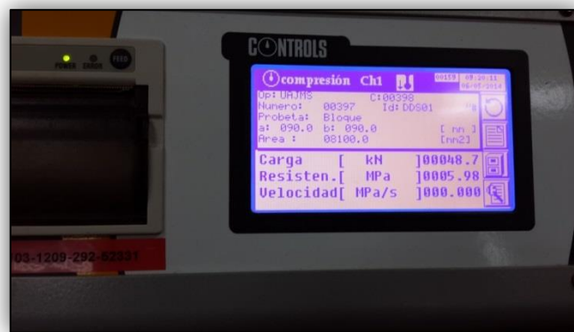
Foto 3.19 Resultado del Ensayo a la Compresión Simple
