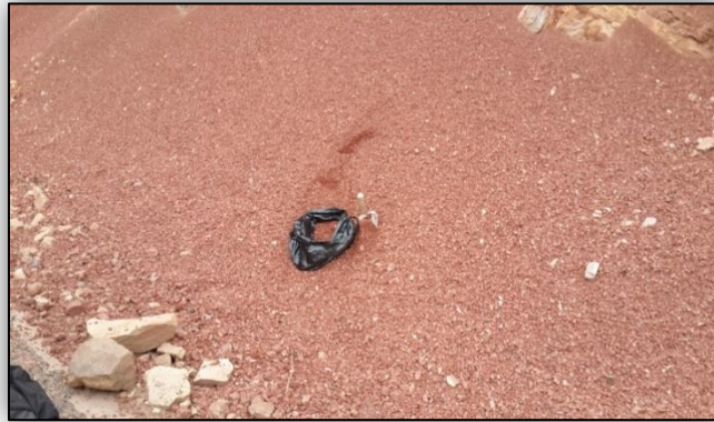
Foto 3.20 Toma de muestra material suelto
