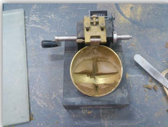
Figura 3.45: Sección de Muestra unida aproximadamente 1.27 cm
