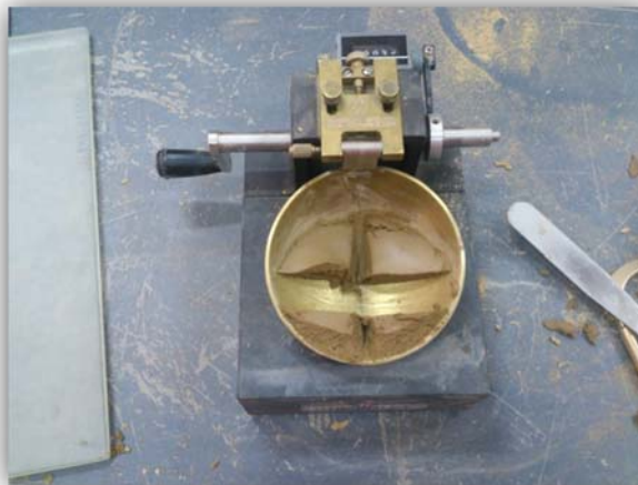
Figura 3.16: Sección de Muestra unida aproximadamente 1.27 cm
