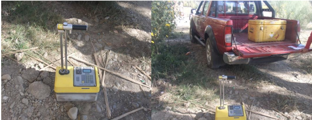
FOTOGRAFIA IV – 7 DENSÍMETRO NUCLEAR (TROXLER SERIE N° 3440) LUIS PIZARRO
