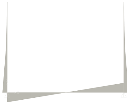
Imagen 5 Diagrama de fuerzas cortantes en la sección transversal del canal.
