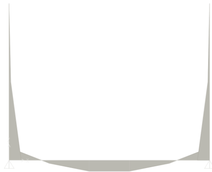
Imagen 4 Diagrama de momentos flectores en la sección transversal del canal.
