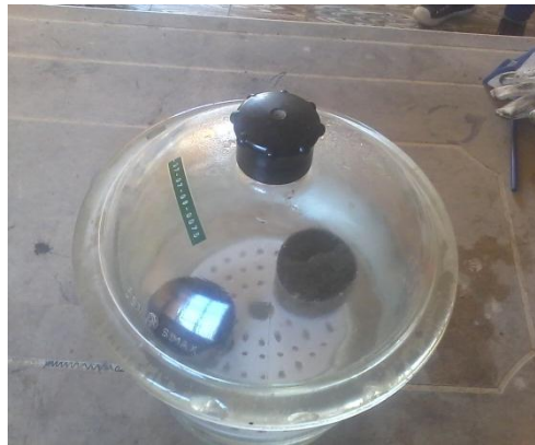
Foto N° 4. Baño de agua de las muestras a 25°C.
