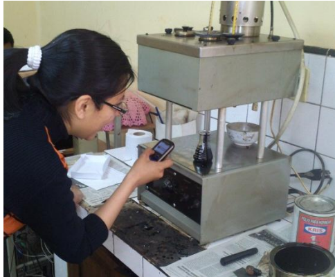
Foto N° 23. Medición en segundos de muestra que fluye en el orificio Furool.
