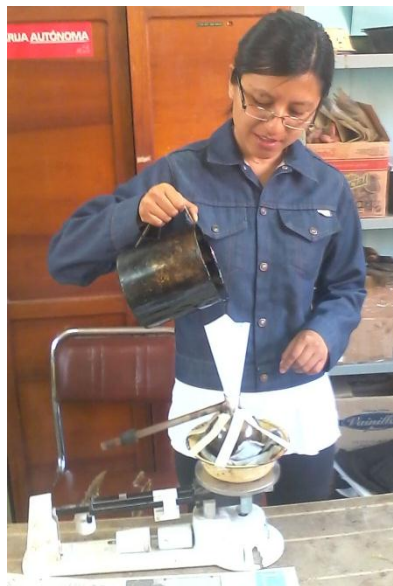
Foto N° 26. Determinación de peso de matraz más asfalto.
