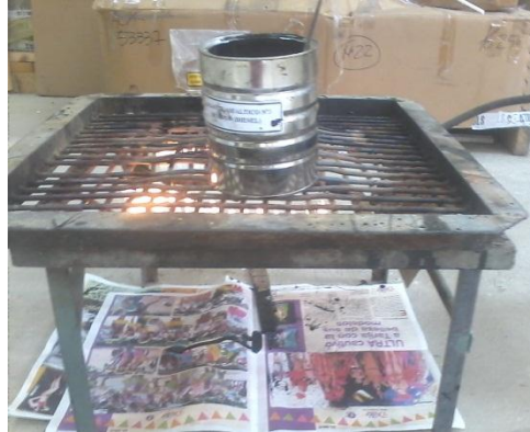
Foto N° 1. Calentamiento de la muestra asfáltica.
