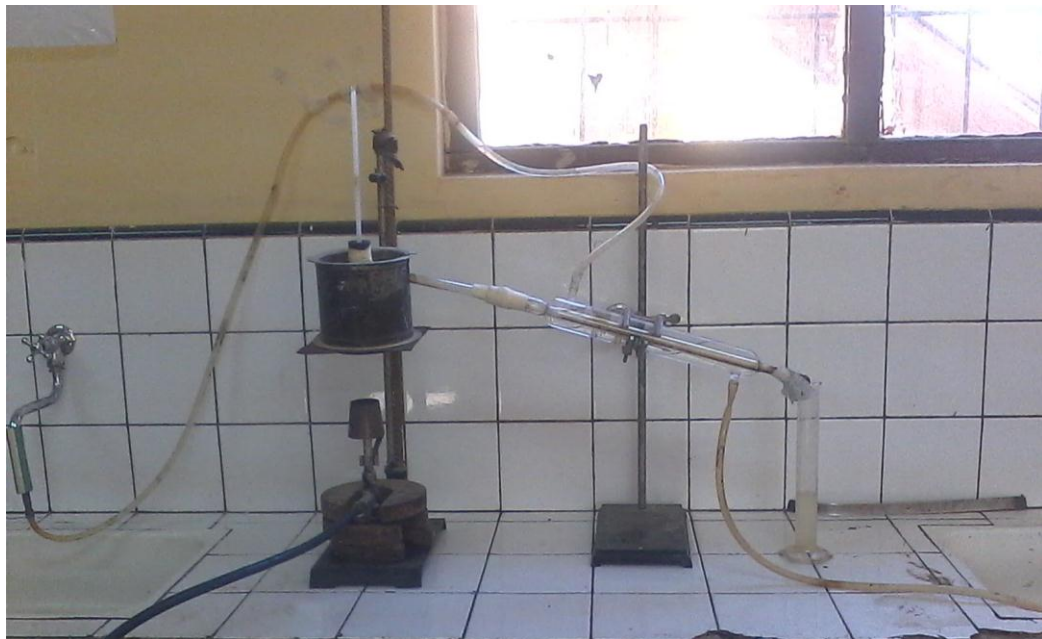
Foto N° 28. Equipo para la Prueba de Destilación.
