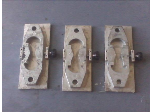
Foto N° 16. Moldes para prueba de Ductilidad.
