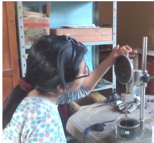
Foto N° 6. Lectura de penetración de la muestra asfáltica.
