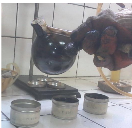
Foto N° 32. Vaciado de muestra en las capsulas.
