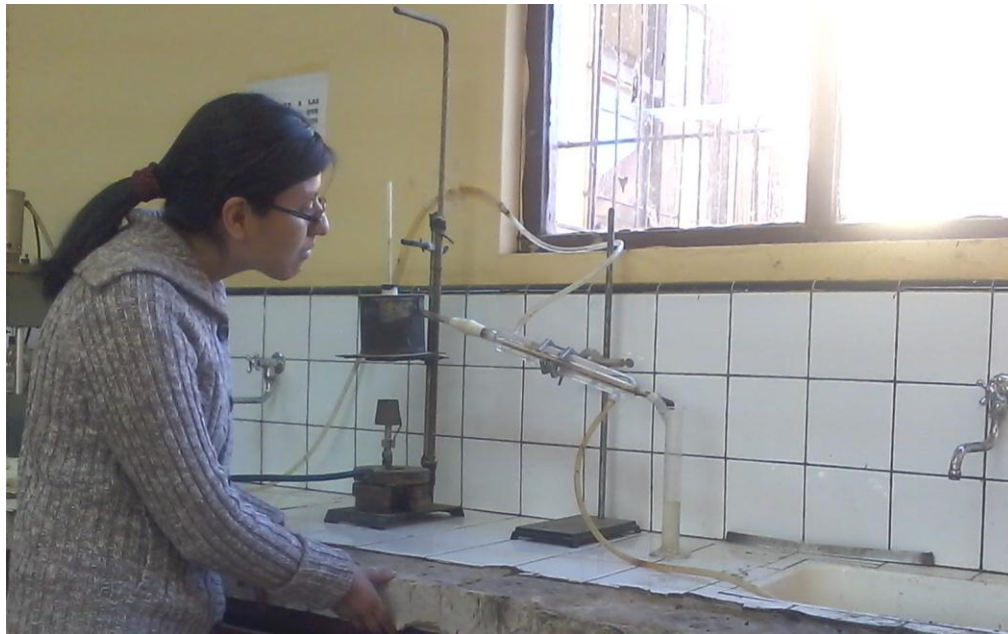
Foto N° 29. Control de temperaturas y volúmenes de destilación.
