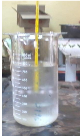
Foto N° 13. Baño de agua de las muestras a 5°C.
