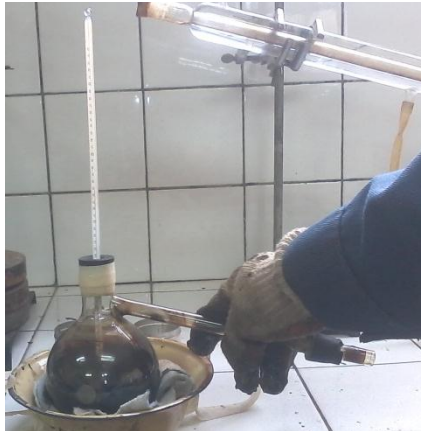
Foto N° 27. Muestra asfáltica en el matraz de destilación.
