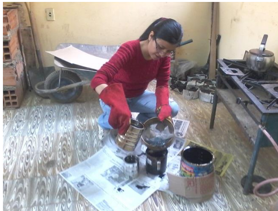
Foto N° 2. Tamizado de la muestra asfáltica.
