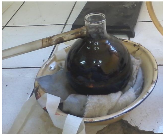
Foto N° 31. Residuo de destilación.
