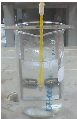
Foto N° 39. Baño de agua de las muestras a 5°C.
