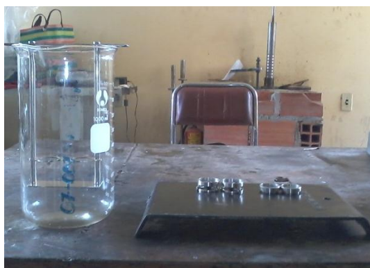
Foto N° 37. Equipo de punto de ablandamiento.
