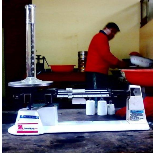
Foto N° 25. Determinación del peso de probeta más agua.
