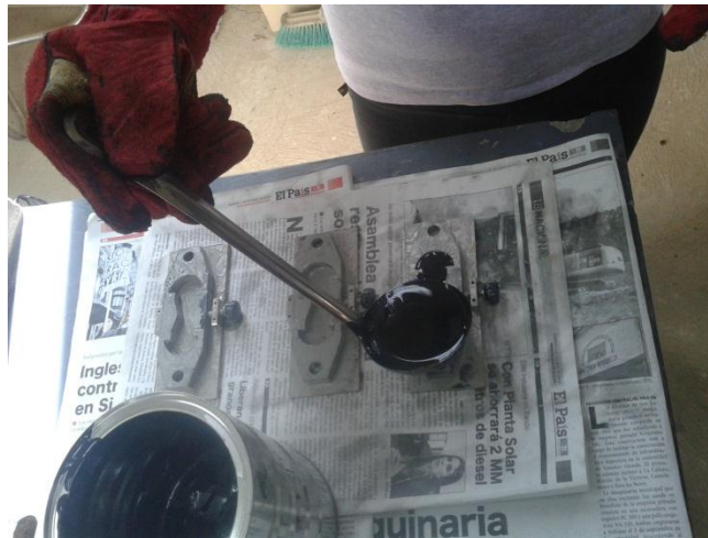
Foto N° 17. Vaciado de muestra en los moldes.
