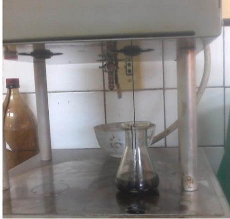
Foto N° 9. Medición en segundos de muestra que fluye en el orificio Furol.
