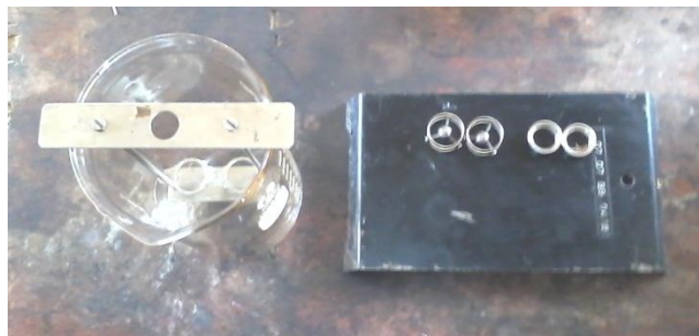
Foto N° 10. Equipo para la prueba de Punto de Ablandamiento.
