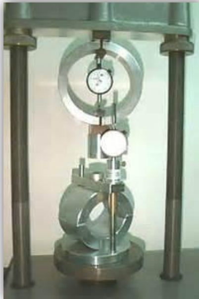
Figura N° 8. Esquema del ensayo Marshall.
