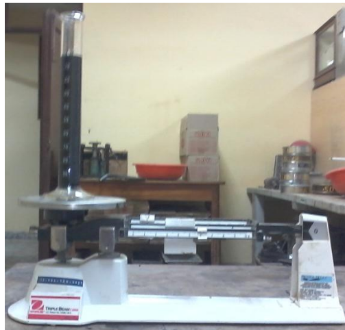
Foto N° 24. Determinación del peso de probeta más asfalto.
