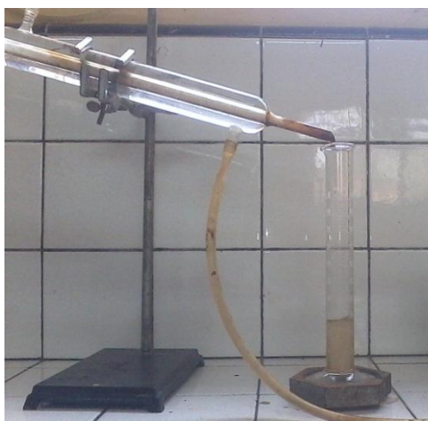
Foto N° 30. Registro de los volúmenes de destilación.
