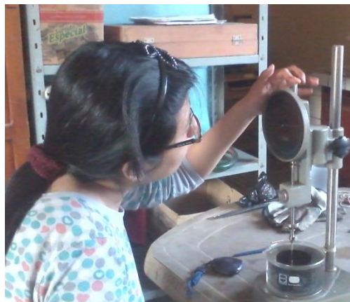
Foto N° 36. Lectura de la muestra asfáltica.
