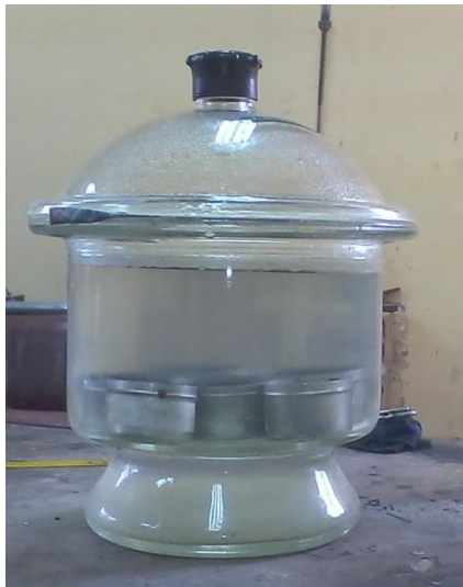
Foto N° 34. Baño de agua de las muestras.
