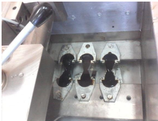
Foto N° 19. Briquetas en el ductilímetro.
