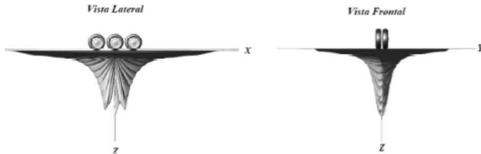
FIGURA 6: ESQUEMA DE UN CUENCO DE DEFLEXION
