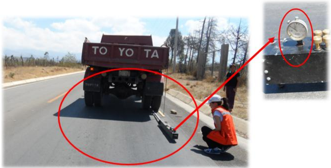
FIGURA 4: LECTURA INICIAL DEL EXTENSOMETRO CON PRECISIÓN DE 0.01
