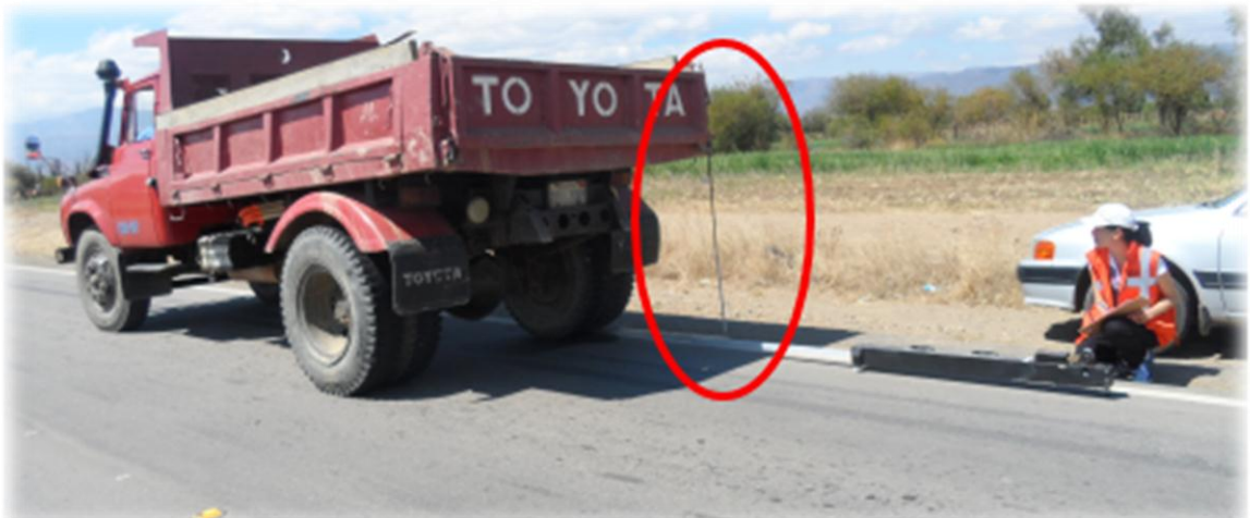
FIGURA 3: MONTAJE DE LA VIGA BENKELMAN
