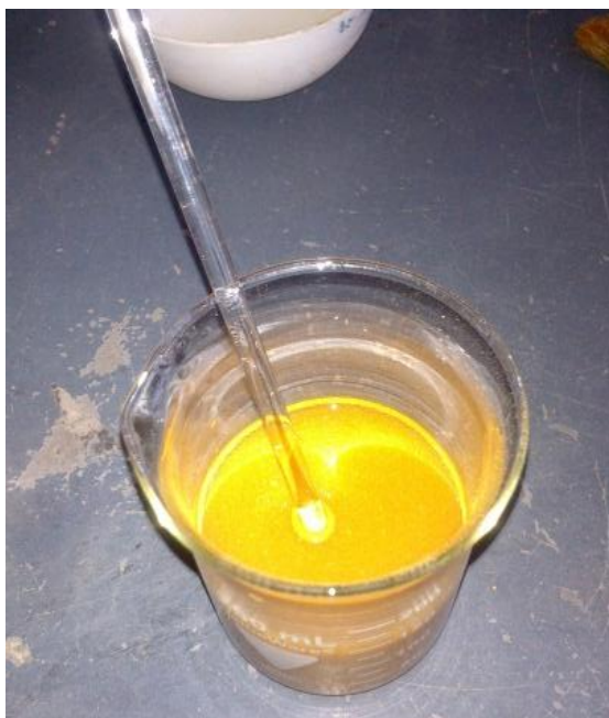
Figura 3.6. Análisis de humectabilidad en agua
