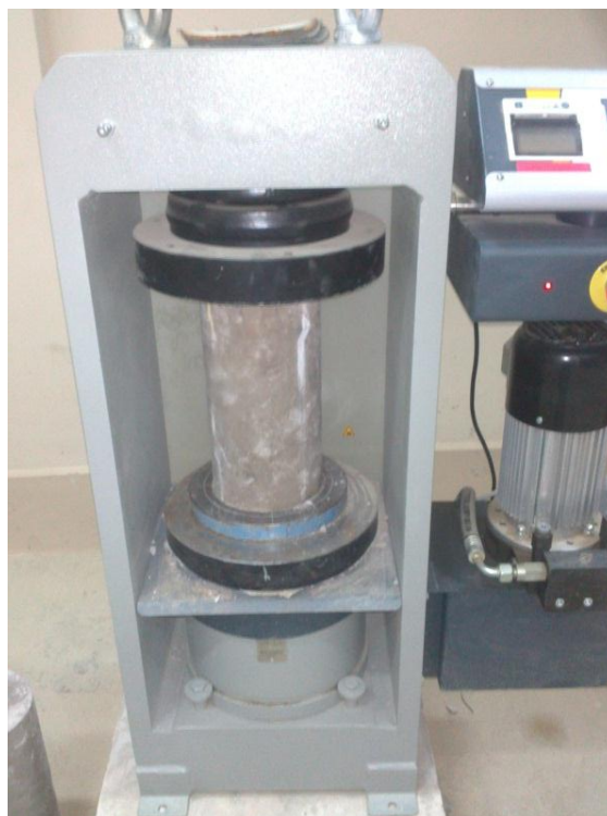
Figura 3.19. Rotura a compresión
