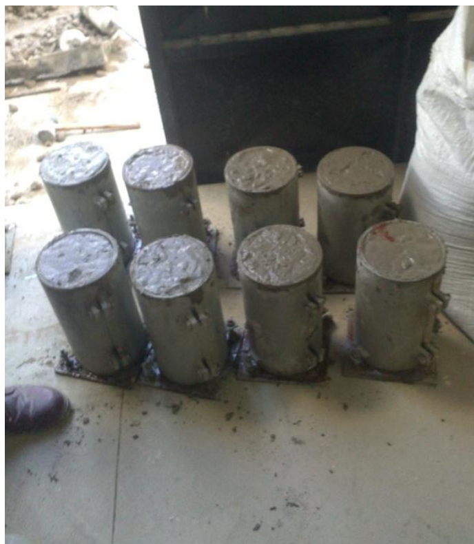
Figura 3.16. Vaciado de probetas en moldes cilíndricos
