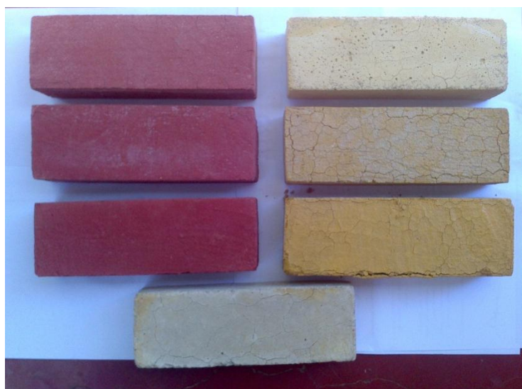
Figura 4.4. Especímenes de mortero a diferentes porcentajes de pigmento y de color, y espécimen de control
