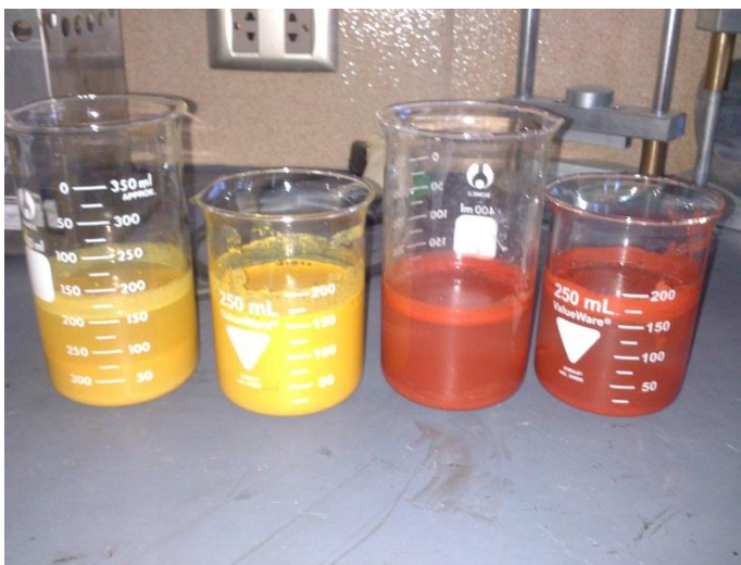
Figura 3.7. Vasos volumétricos con el pigmento con la solución de hidróxido de sodio.
