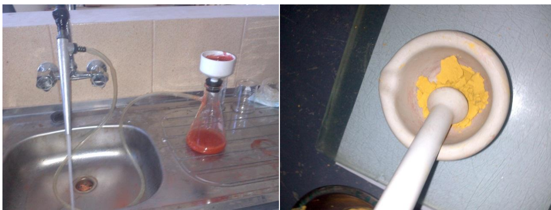
Figura 3.8. Filtrado con embudo de Buchner (izquierda) mediante vacío y. Molienda de la muestra después de secada al horno.
