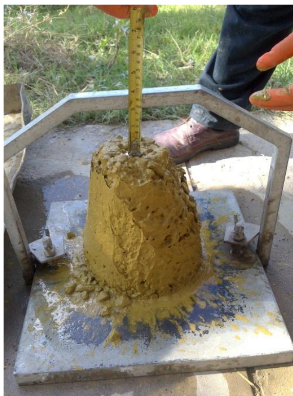
Figura 3.18. Ensayo de Asentamiento con el cono de Abrams
