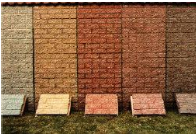
Figura 2.4 Acción del intemperismo en especímenes pigmentados
