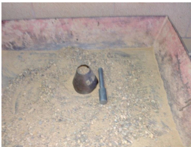
Figura 3.4. Molde y varilla para peso específico de la arena FUENTE: Elaboración propia.
