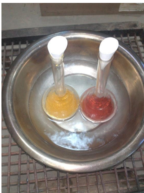
Figura 3.9. Cocción de la solución (izquierda) y filtrado de la solución (derecha)
