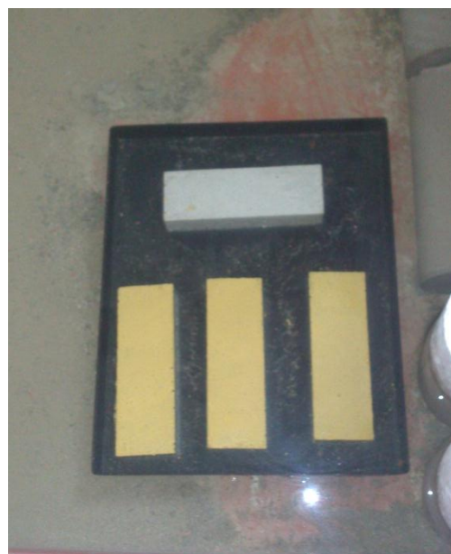
Figura 3.14. Especímenes de mortero en proceso de curado
