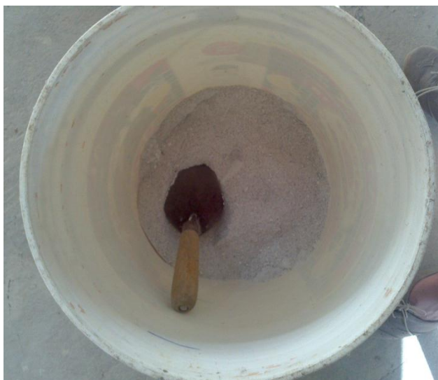
Figura 3.11. Mezcla de mortero para el llenado de los moldes de madera.
