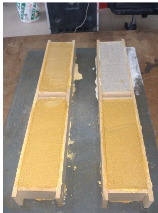
Figura 3.13. Especímenes de mortero terminados, en los moldes de madera
