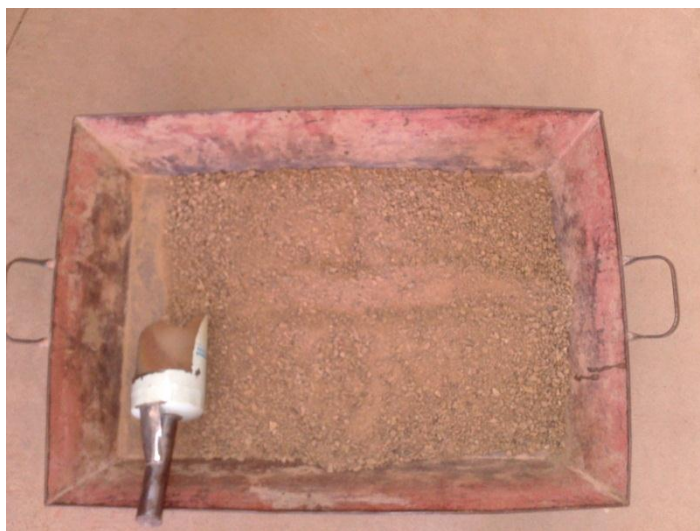
Figura 3.2 Cuarteo del agregado fino FUENTE: Elaboración propia.
