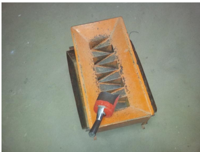
Figura 3.1 Cuarteo del agregado grueso FUENTE: Elaboración propia.
