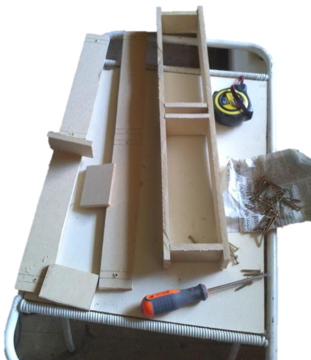
Figura 3.10. Moldes de madera para elaboración de especímenes de mortero con medidas de 9" x3" x2"
