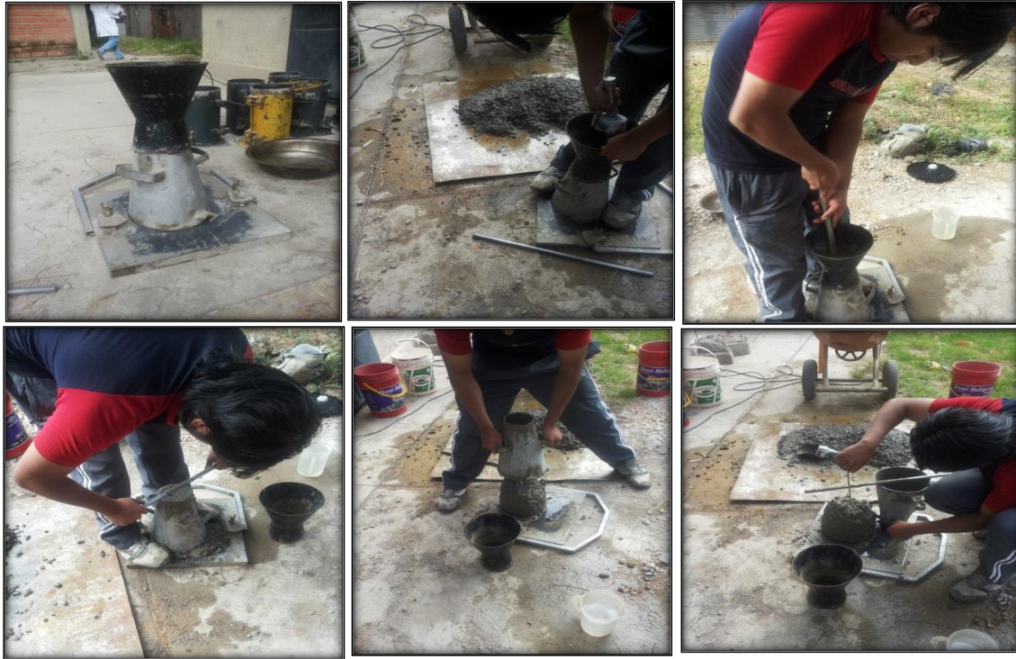
Figura 3.7. Ensayo de asentamiento en mezcla de hormigón
