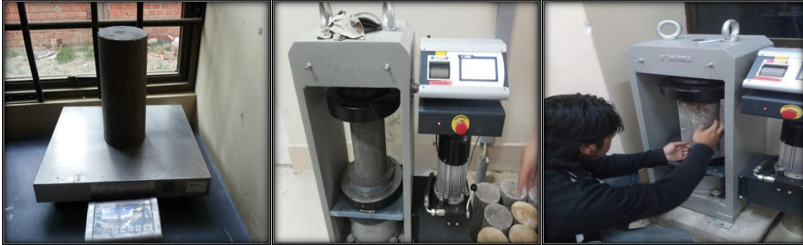
Figura 3.10. Ensayo a compresión de especímenes de hormigón
