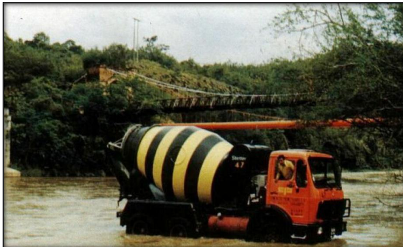
Figura 2.1. Transporte del hormigón con aditivo retardador
