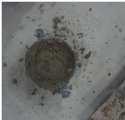
Figura 3.21. Molde más suelo compactado
