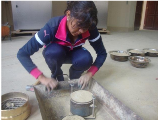
Figura 3.17. Enrasando el suelo compactado al molde
