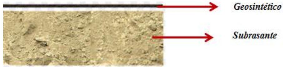
Fig. N°31 Geosintético colocado en la superficie
