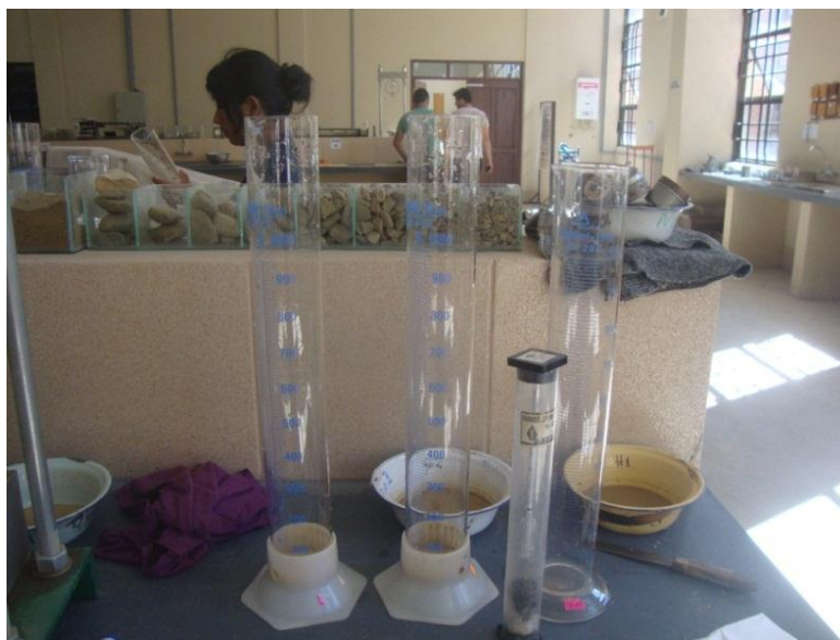
Figura 3.8. Material necesario para el análisis hidrométrico
