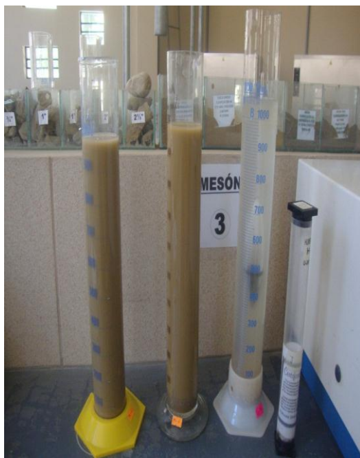
Figura 3.10. Probetas con el suelo para sedimentar
