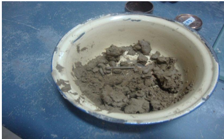
Figura 3.14. Muestra preparada para el Limite Plástico
