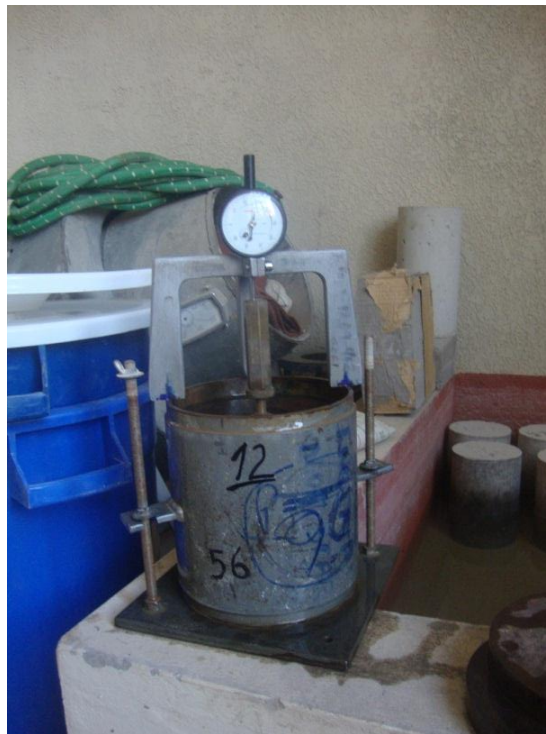
Figura 3.23. Lecturando la expansión con el extensómetro
