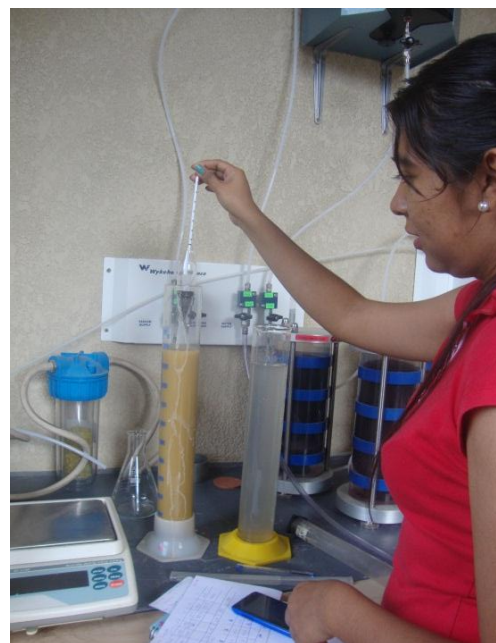
Figura 3.11. Lectura del hidrómetro y temperatura y temperatura
