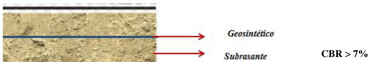
Figura N°4.2. Subrasante reforzada con geosintético colocado en la mitad
