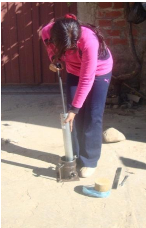
Figura 3.26. Compactación de capas
