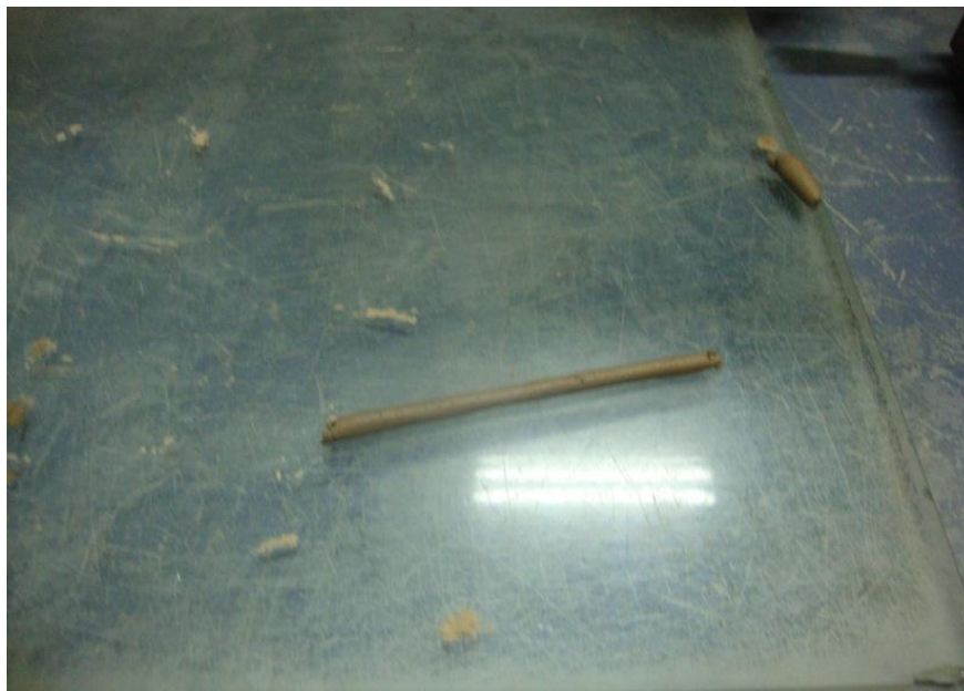
Figura 3.15. Rollitos de 3mm para límite plástico
