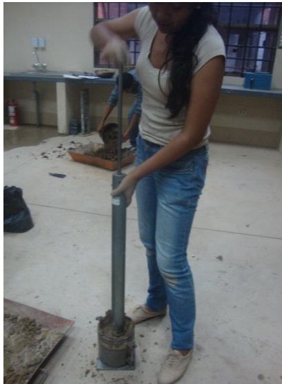
Figura 3.20. Compactando el suelo
