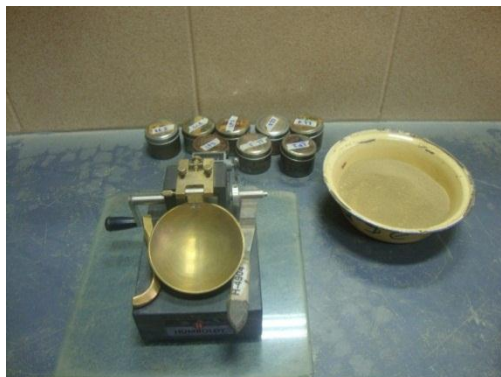
Figura 3.13. Material necesario para Limite Líquido
