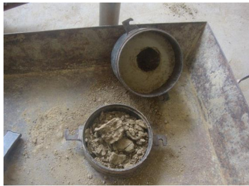
Figura 3.18. Desmoldando para extraer humedad
