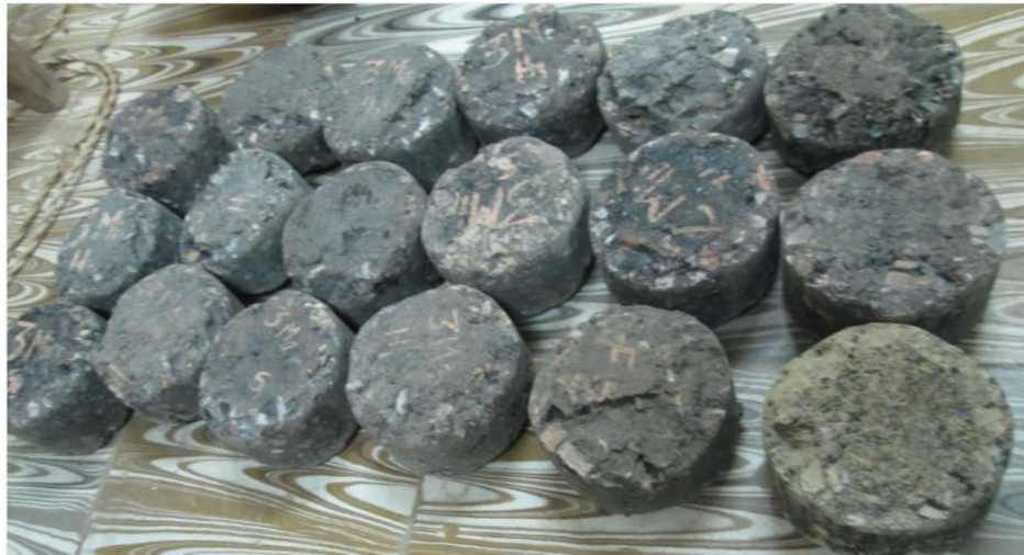
Figura N°54 Grupo de briquetas desgastadas para la temperatura mínima
