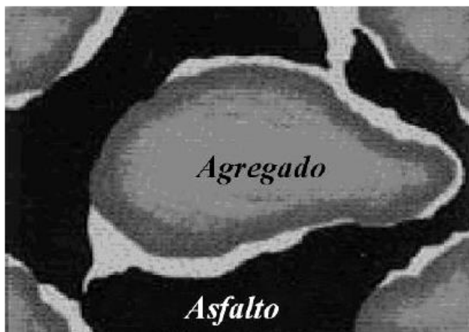
Figura N°6 Desprendimiento del ligante del agregado
