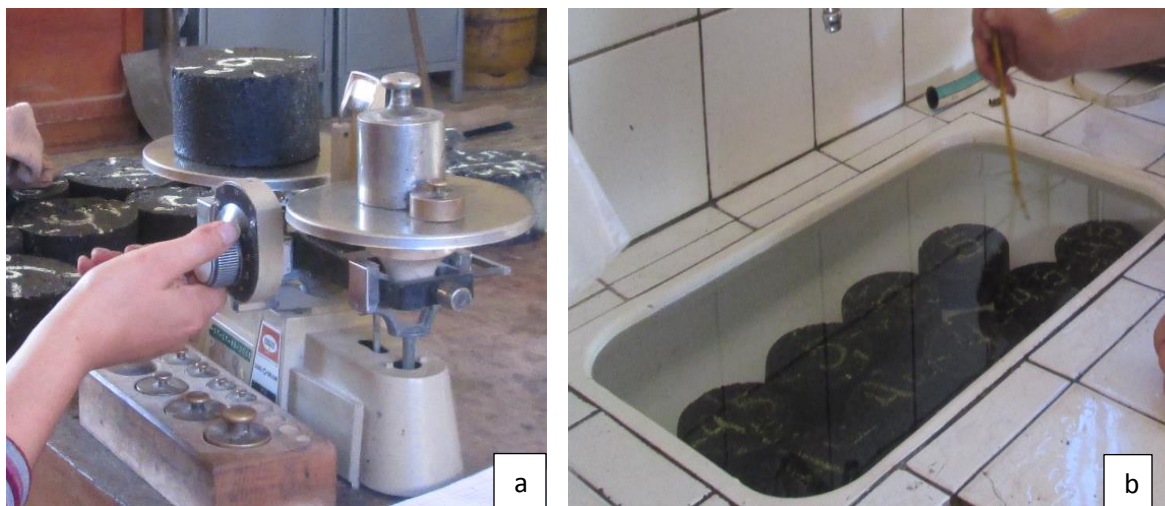
Figura N°48 a) Peso de la briqueta seca b) Briquetas sumergidas
