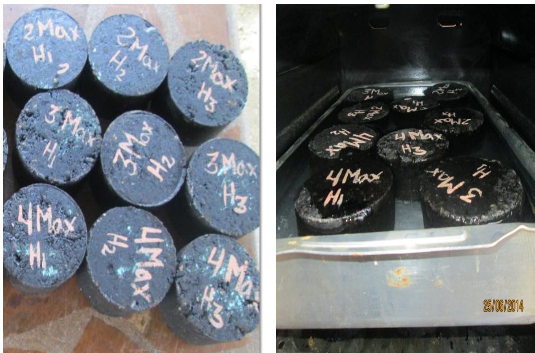
Figura N°58 a) Mezclas asfálticas para cada periodo b) Briquetas sumergidas en agua y sometidas a temperatura máxima 40°C
