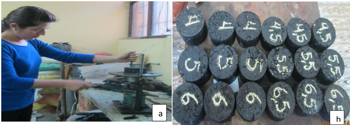
Figura N°47 a) Extracción de la briqueta b) briquetas para el contenido óptimo
