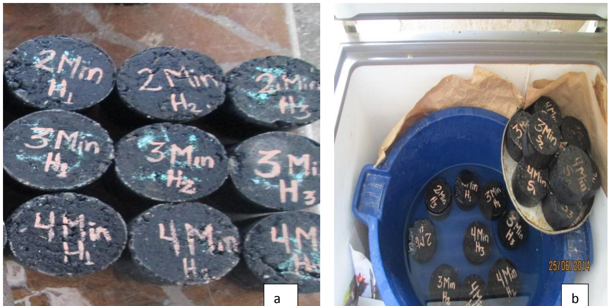
Figura N°51 a) Mezclas asfálticas enumeradas b) Briquetas sumergidas en agua
