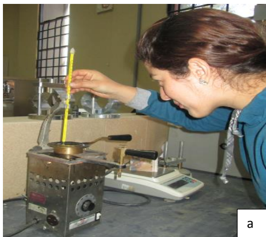
Figura N°43 a) El material comienza a calentarse b) Se aplica la llama a la copa
