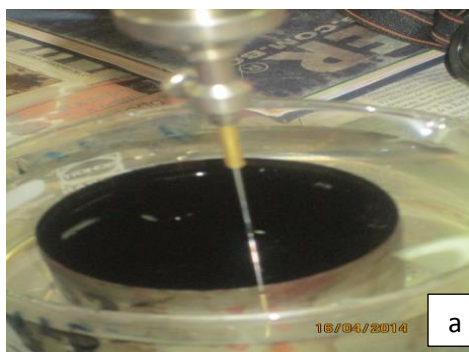
Figura N°35 a) Aguja penetrando en la muestra b) Lectura en el penetrometro
