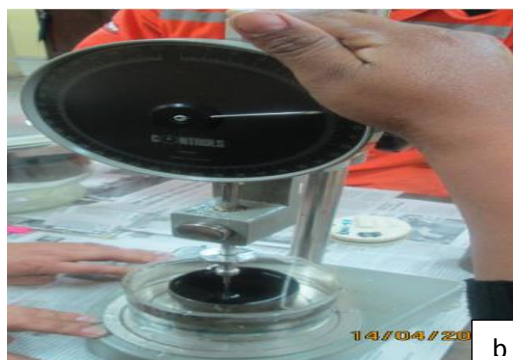
Figura N°35 a) Aguja penetrando en la muestra b) Lectura en el penetrometro
