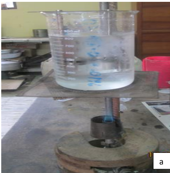
Figura N°40 a) Vaso precipitado sometido a calor b) El asfalto se desprende de los anillos
