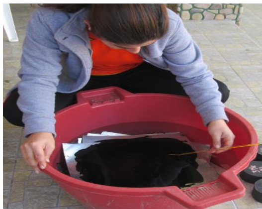
Figura N° 64 Láminas de C.A sumergidas a temperatura media
