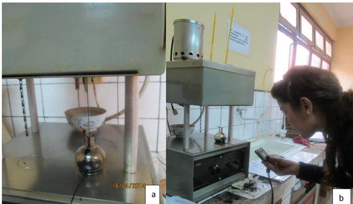
Figura N°36 a) Asfalto que cae a 135°C b) Control de tiempo
