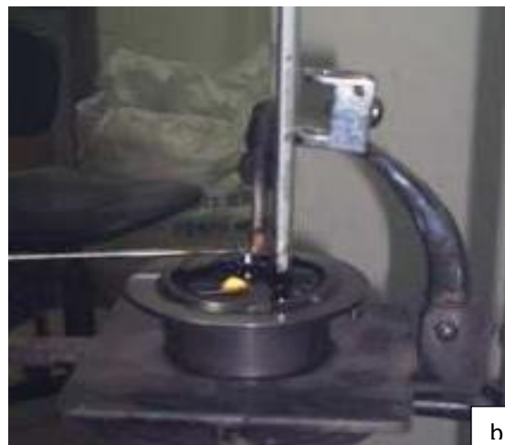
Figura N°43 a) El material comienza a calentarse b) Se aplica la llama a la copa
