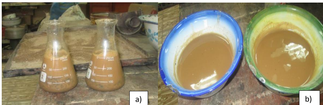
Figura N°24 a) Matraz con muestra y agua b) Muestra antes de entrar en el horno
