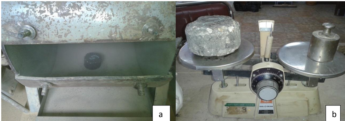
Figura N°52 a) Briquetas en la máquina de los Ángeles a) Briquetas desgastada
