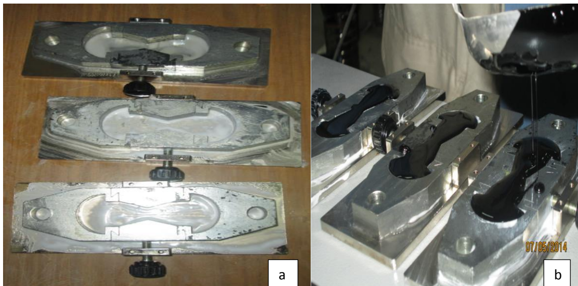
Figura N°41 a) Briquetas con vaselina y talco b) Briquetas llenas de asfalto
