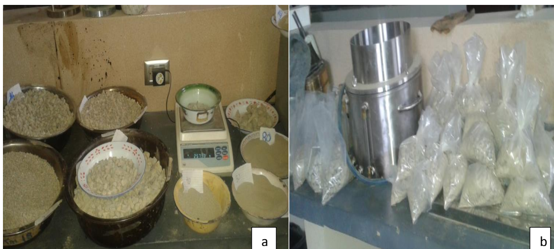
Figura N°44 a) Material separado por tamices b) Bolsas con 1200gr
