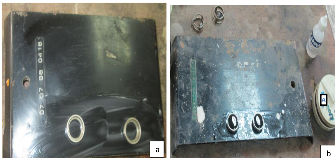
Figura N°39 a) Anillos con vaselina y talco b) Anillo con asfalto enfriando
