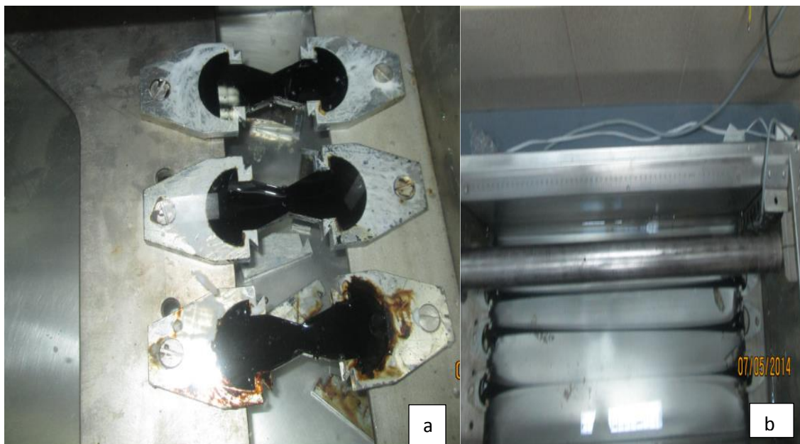
Figura N°42 a) Briquetas en el equipo b) briquetas en proceso de extensión
