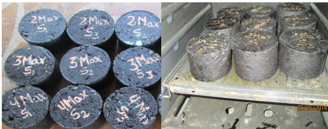
Figura N°59 a) Briquetas grupo seco b) Briquetas grupo seco expuestas a máxima temperatura
