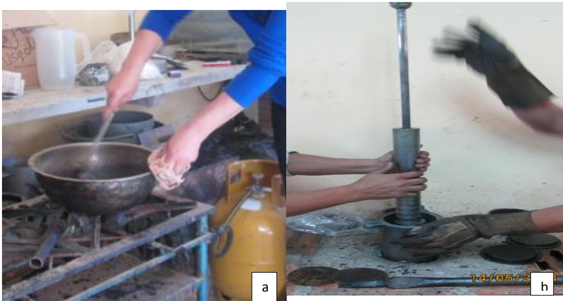
Figura N°46 a) Mezclado de muestra b) Compactación con martillo
