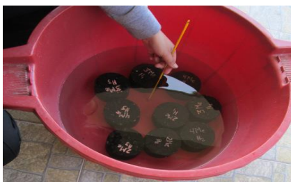
Figura N°55 Briquetas sumergidas en agua a temperatura media 17°C
