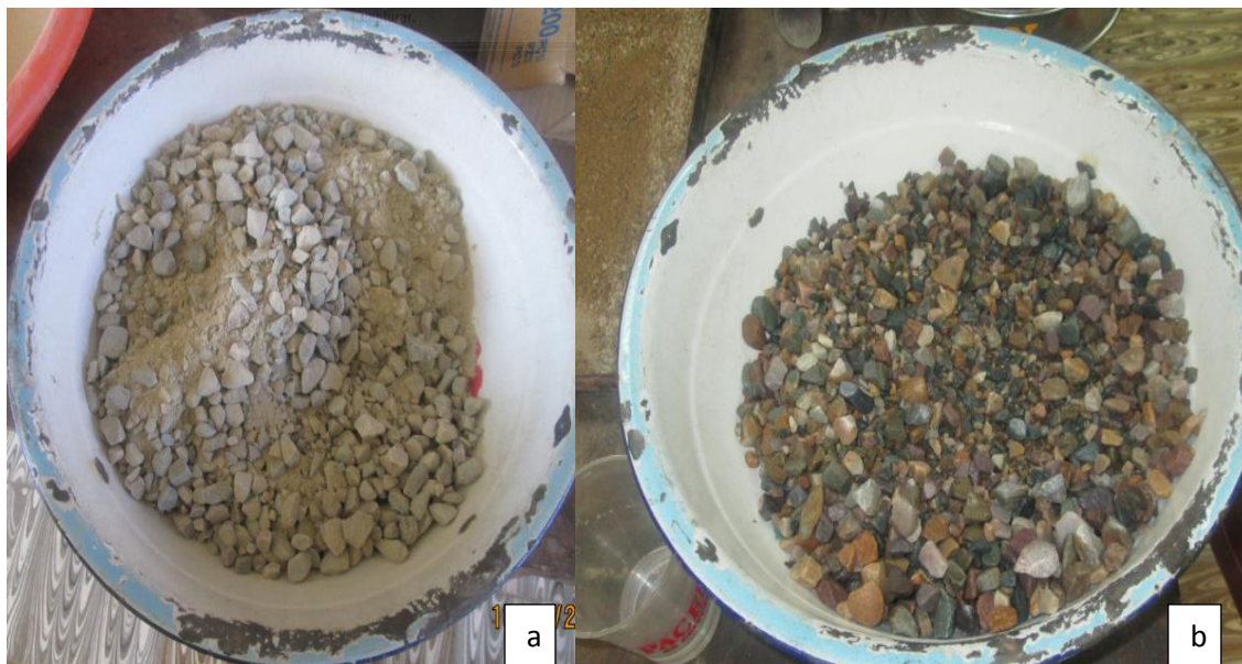
Figura N°30 a) Material desgastado b) Material lavado y secado en el horno 24hrs
