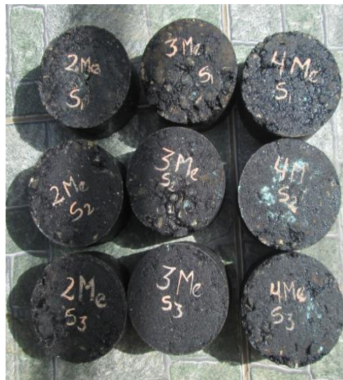
Figura N°56 Briquetas grupo seco enumeradas para cada etapa a temperatura media 17°C
