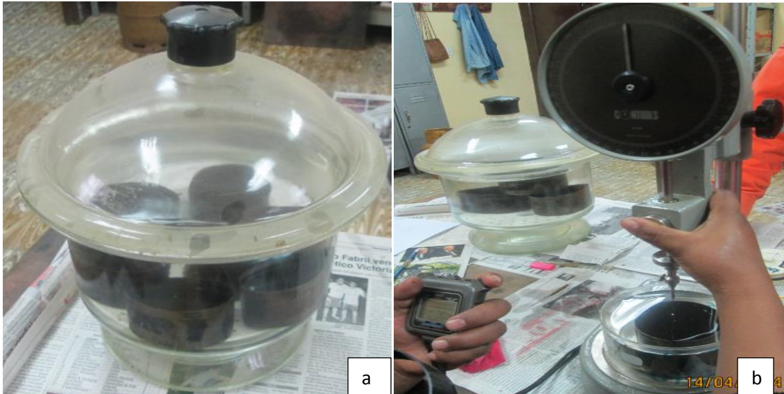
Figura N°34 a) Muestras sumergidas b) Control de tiempo para penetración 5s
