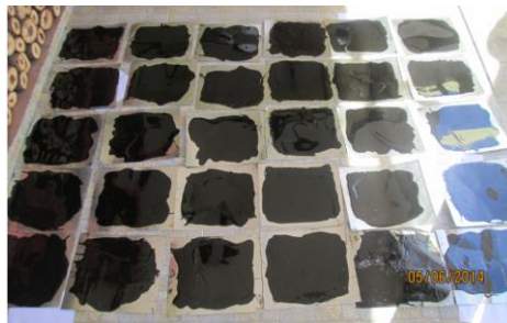
Figura N°61 Láminas de cemento asfáltico previo al acondicionamiento
