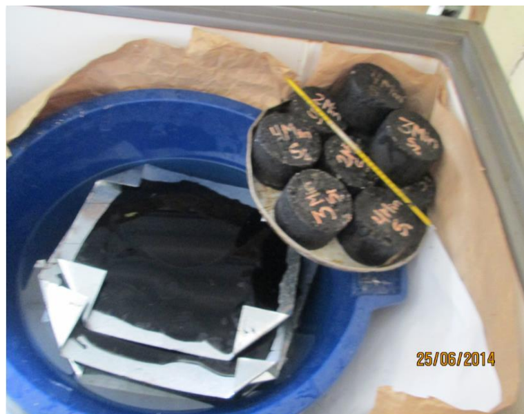
Figura N°63 Muestras sumergidas a temperatura Mínima
