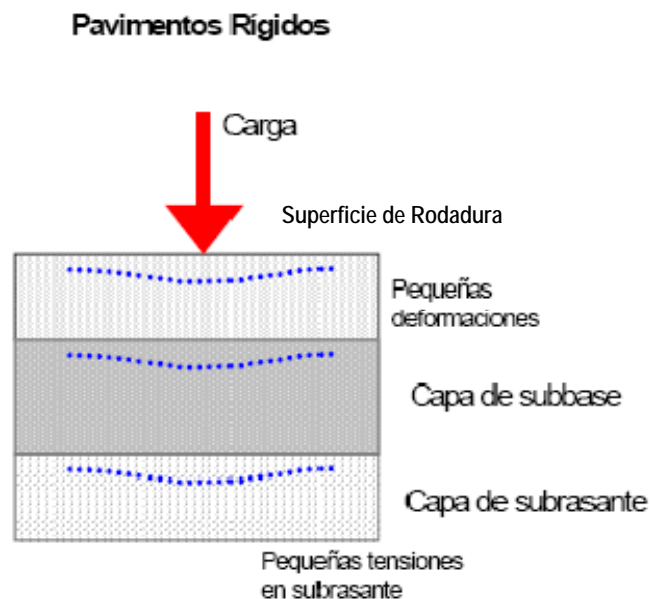
Fig. 2.1 Estructura de un Pavimento Rígido
