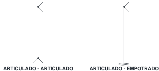
Figura 2.23. Modelos estructurales de estribos.
