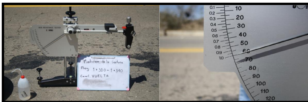
FIGURA 9 Ensayo de Fricción con péndulo británico
