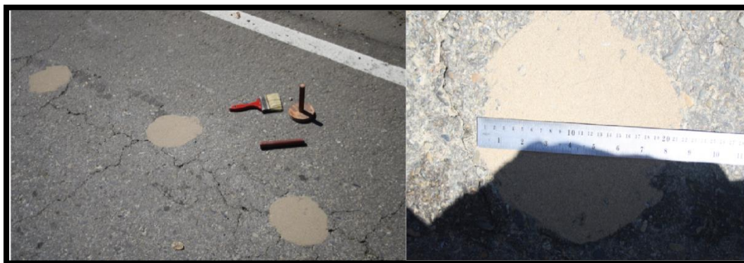
FIGURA 10 Ensayo del círculo de arena para la determinación de la textura
