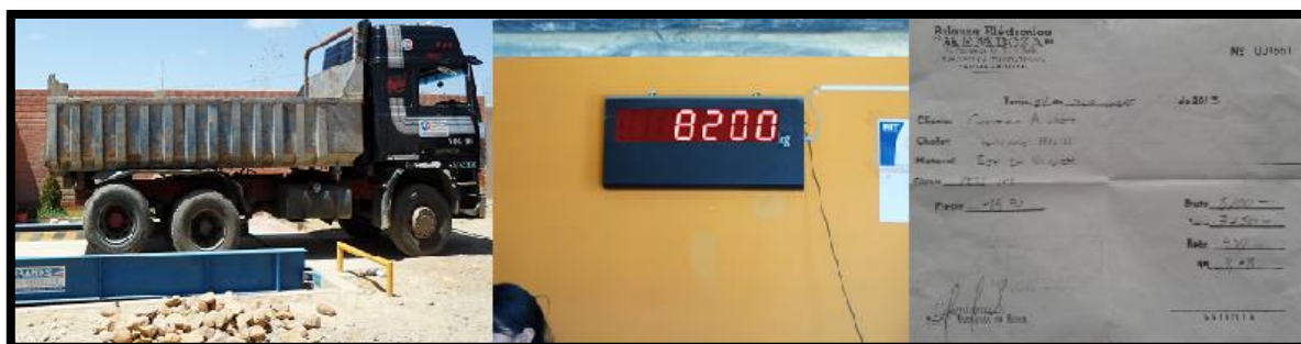
FIGURA 11 Calibración de la volqueta para el ensayo de Viga Benkelman Fuente: Elaboración Propia
