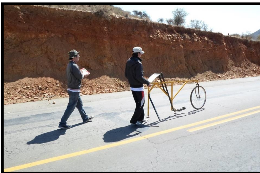
FIGURA 6 Medición en campo con el perfilómetro Merlín
