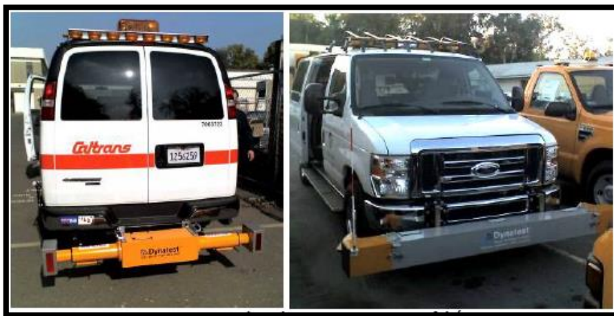
FIGURA 69 Perfilometro laser de alta frecuencia
