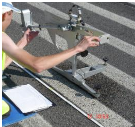
Figura 2.1 Medida de la resistencia al deslizamiento de una marca vial con el péndulo de rozamiento.
