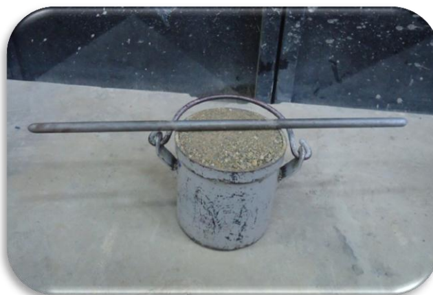
Fotografía 31. Molde Cilíndrico con Muestra de Arena Compactado
