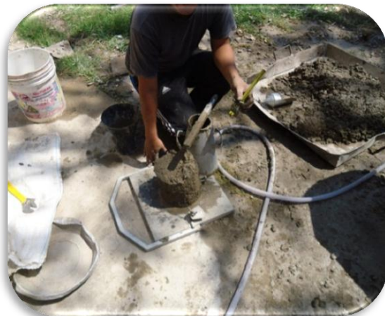
Fotografía 45. Ensayo de Cono de Abrams
