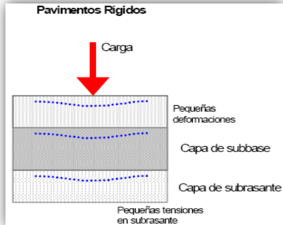
Figura 4. Esquema de Comparación de Pavimento Rígido
