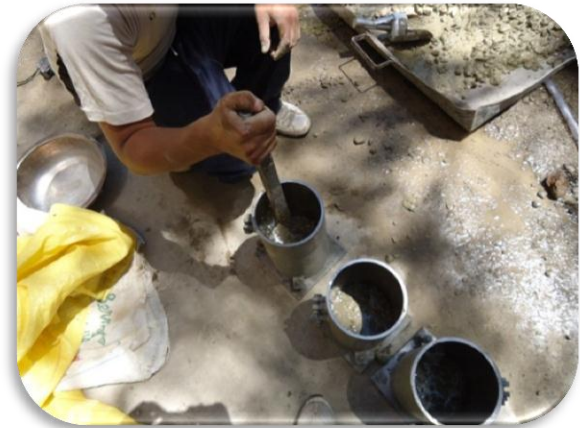
Fotografía 49. Vaciado de los moldes con Aditivo
