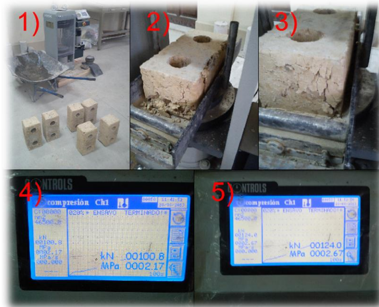
Figura N°26: Diversas fotografías de los Eco-ladrillos siendo ensayados a compresión simple
