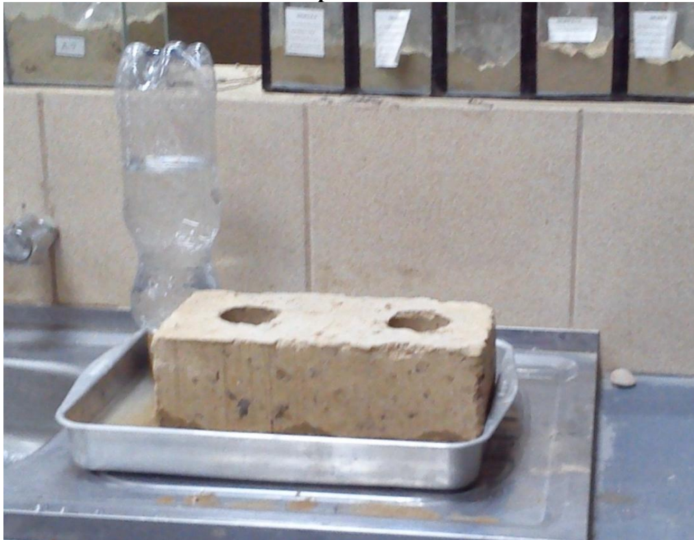
Figura N°24: Equipo para la determinación de la absorción de agua por capilaridad
