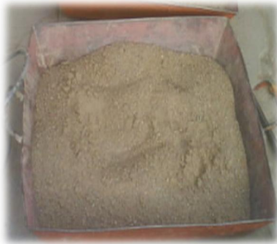
Figura N°20: Muestra tamizada y pesada para la confección de Eco-ladrillos.
