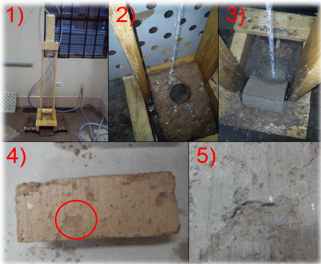
Figura N°23: Diversas fotografías del ensayo de erosión acelerada.
