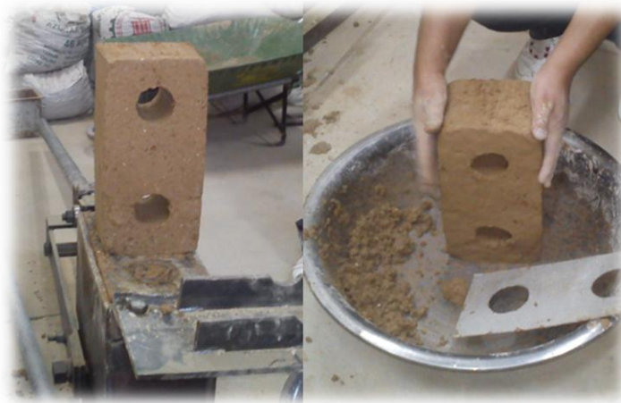
Figura N°17: Fotografía de Eco-ladrillos con diferente humedad.
