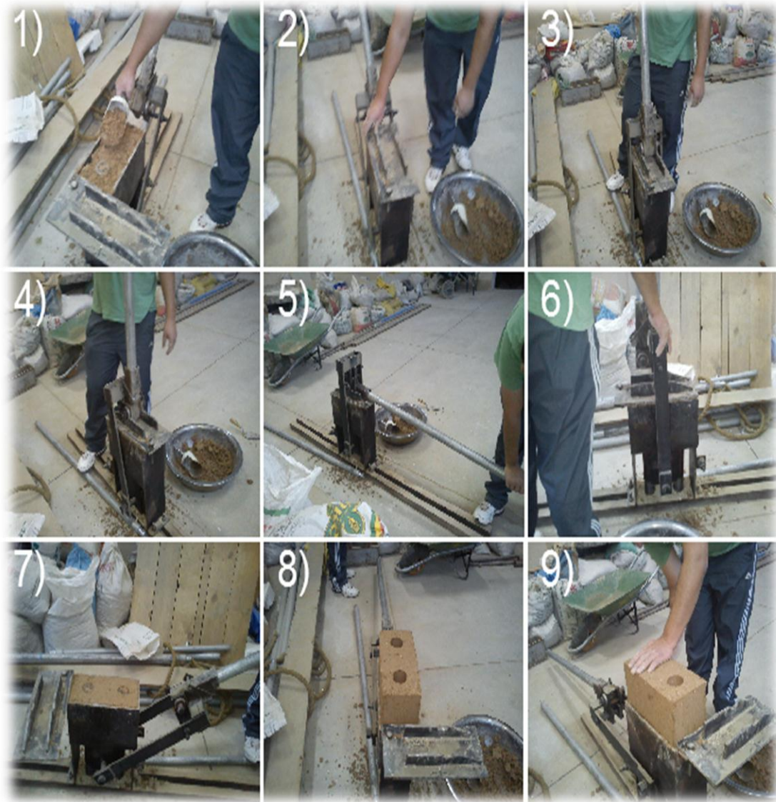
Figura N°22: Proceso de elaboración de un Eco-ladrillo
