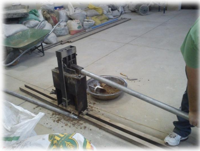
Figura N°15: Fotografía CETA-RAM II, construida para el estudio.
