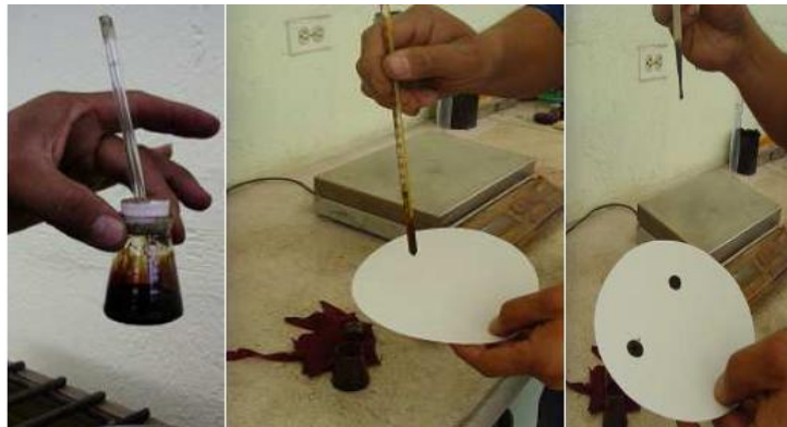
FIGURA 4. 24 - Tomando muestra para dejar caer en el papel filtro Fuente: Elaboración propia
