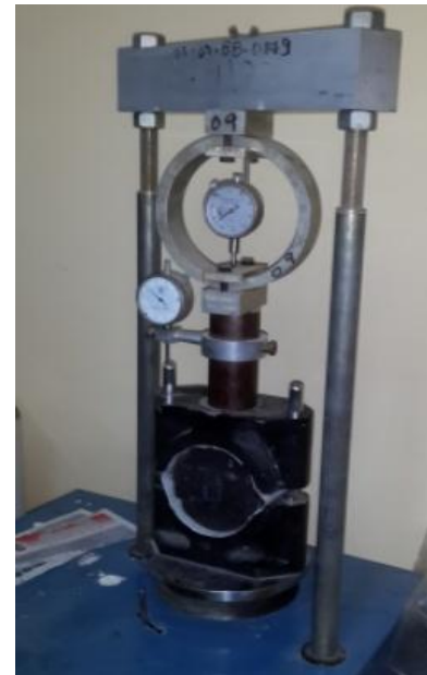
FIGURA 4. 32 Determinación de Estabilidad y flujo con la Marshall Fuente: Elaboración propia
