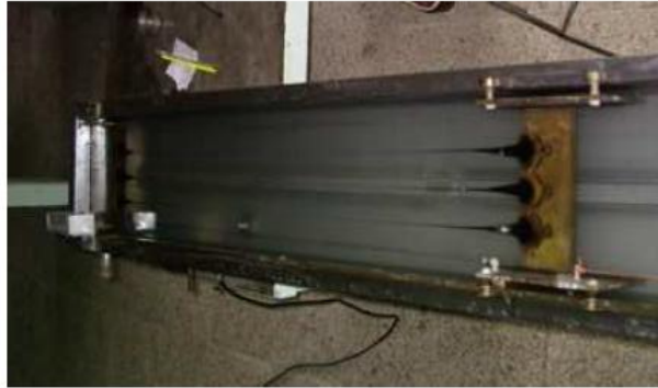
FIGURA 4. 21 – Elongación del asfalto en el equipo ductilómetro
