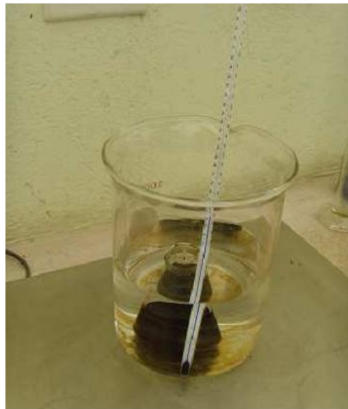
FIGURA 4. 17 - Baño de agua a 25°C conjunto picnómetro + asfalto + agua
