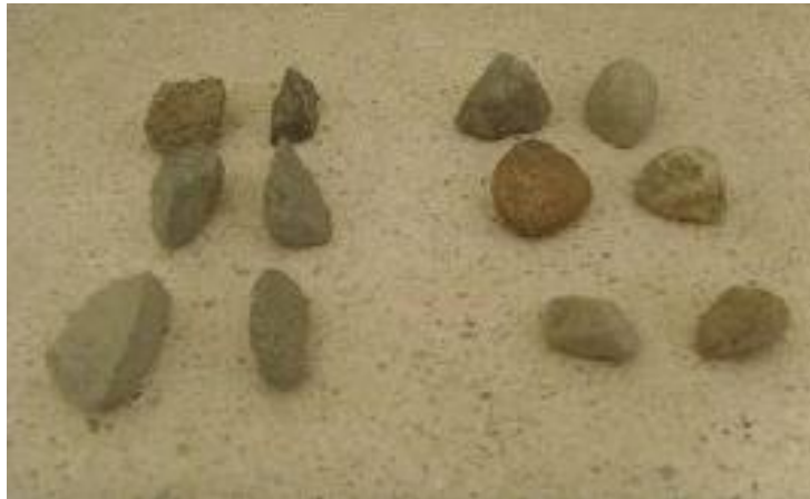
FIGURA 4.2 - Separando las partículas fracturadas y no fracturadas
