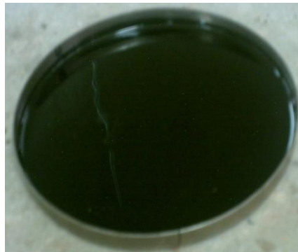
FIGURA 4. 27 - Cazuela tarada con asfalto
