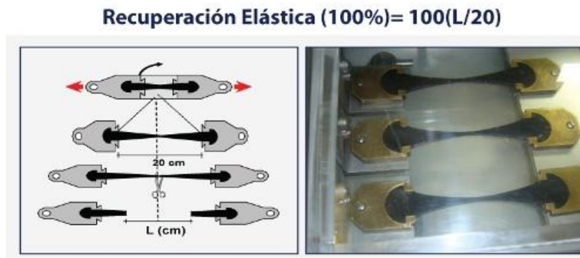
FIGURA 4. 25 - Procedimiento de recuperación elástica
