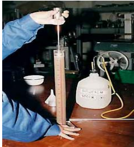
FIGURA 4.5 - Probeta para equivalente de arena con muestra y accesorios
