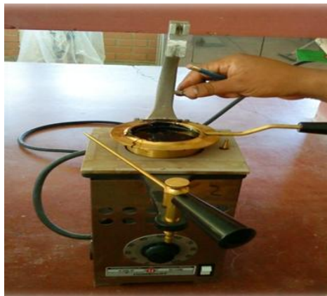
FIGURA 4.18 - Aparato armado copa abierta de Cleveland
