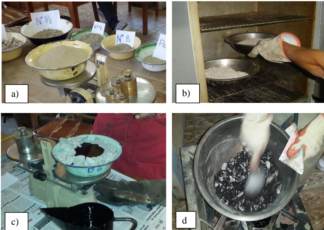
FIGURA 4. 29 - a) muestra tamizada, b) secado en el horno, c) pesado de la muestra, d) preparación de mezcla
