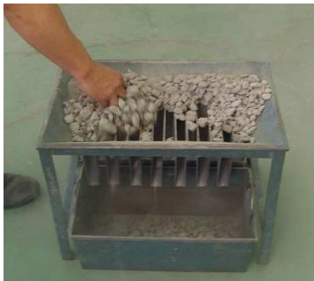
FIGURA 4.3 - Cuarteo de muestra
