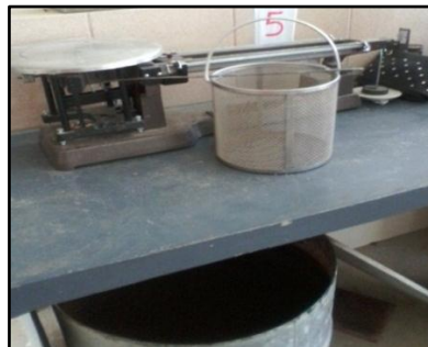
Figura 3.3. Equipo para realizar peso específico aparente de la grava
