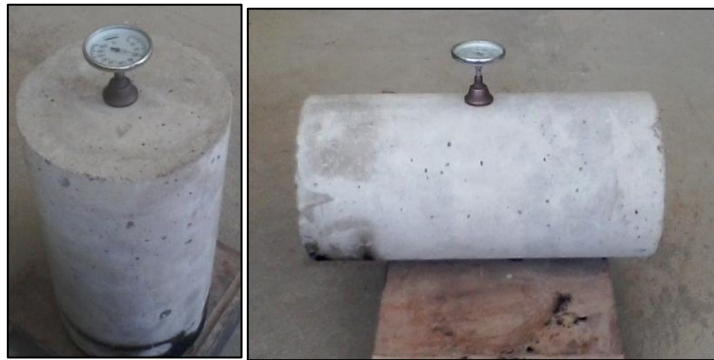
Figura 3.26. Medición de la temperatura
