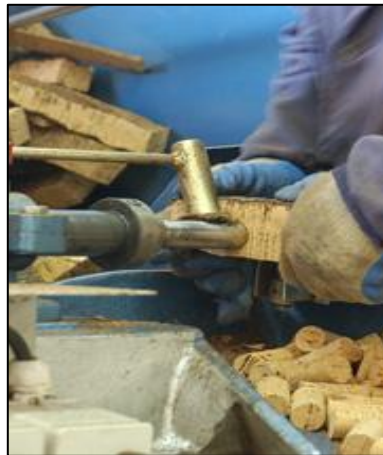
Figura 2.12. Perforación del tapón o disco natural
