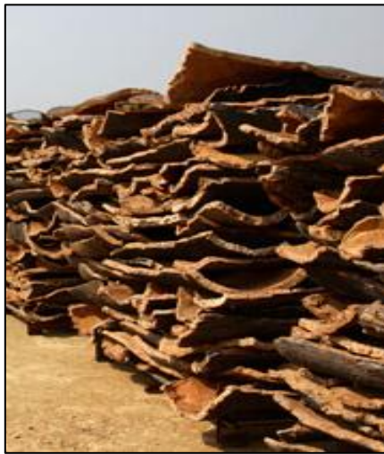
Figura 2.9. Estabilización del corcho en bruto
