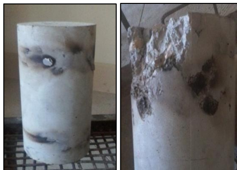
Figura 3.22. Probetas al 80% de reemplazo de grava, después de 30 minutos de estar en contacto con el fuego
