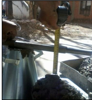
Figura 3.8. Ensayo de cono de Abrams del hormigón patrón
