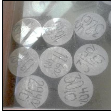
Figura 3.10. Curado de probetas en agua
