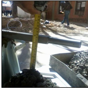
Figura 3.13. Ensayo de cono de Abrams para el 20% de reemplazo de grava
