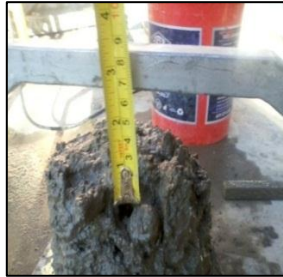
Figura 3.14. Ensayo de cono de Abrams para el 40% de reemplazo de grava
