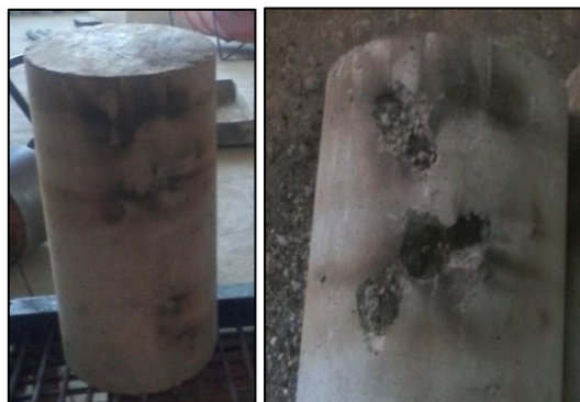
Figura 3.20. Probetas al 40% de reemplazo de grava, después de 30 minutos de estar en contacto con el fuego
