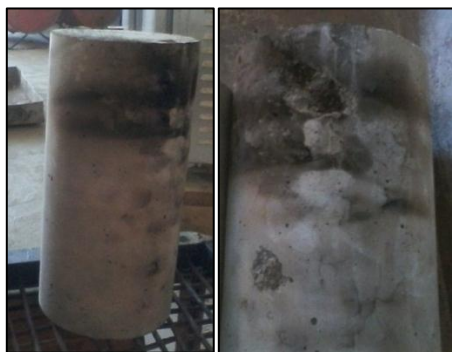
Figura 3.21. Probetas al 60% de reemplazo de grava, después de 30 minutos de estar en contacto con el fuego
