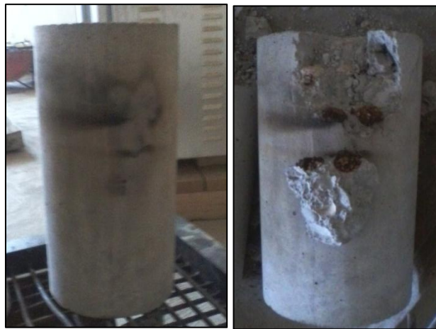
Figura 3.19. Probetas al 20% de reemplazo de grava, después de 30 minutos de estar en contacto con el fuego
