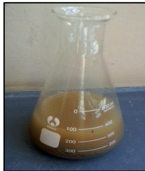
Figura 3.5. Matraz graduado para peso específico aparente de la arena
