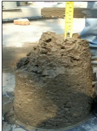
Figura 3.17. Ensayo de cono de Abrams para el 100% de reemplazo de grava
