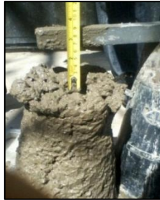
Figura 3.16. Ensayo de cono de Abrams para el 80% de reemplazo de grava
