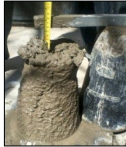
Figura 3.15. Ensayo de cono de Abrams para el 60% de reemplazo de grava
