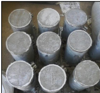
Figura 3.9. Pasta de hormigón colocada en moldes cilíndricos
