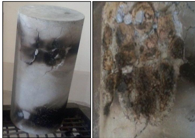
Figura 3.23. Probetas al 100% de reemplazo de grava, después de 30 minutos de estar en contacto con el fuego
