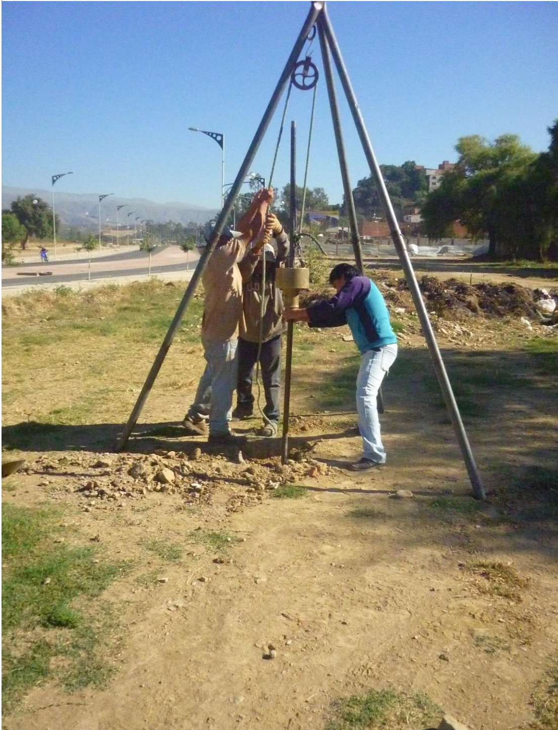
Figura 3.25.- Ensayo de SPT en el punto No 5
