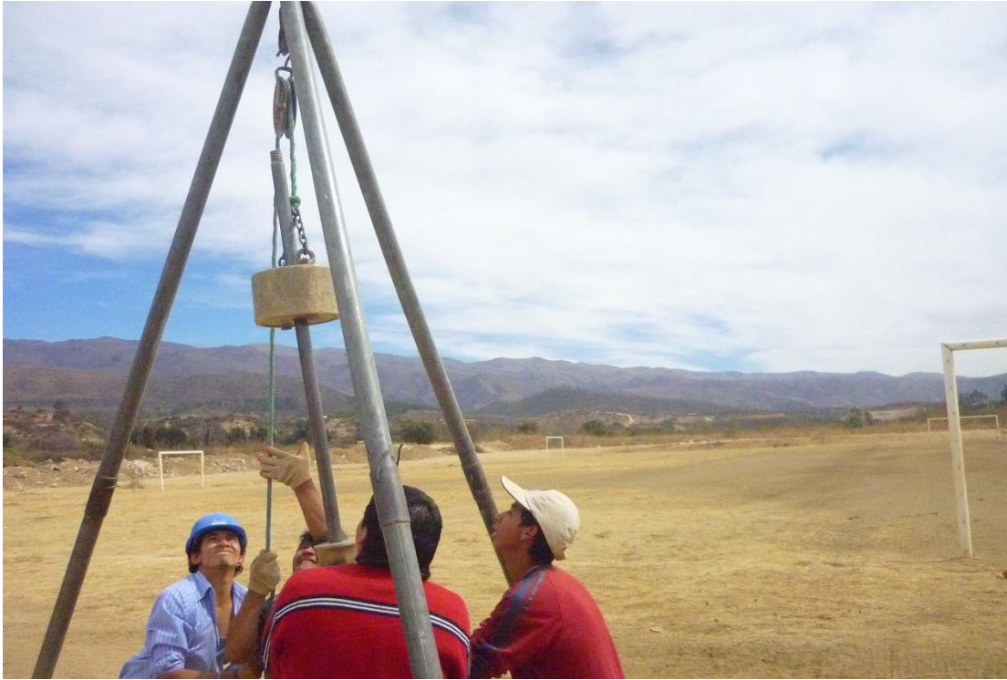
Figura 3.28.- Ensayo de SPT en el punto No 6 (1)
