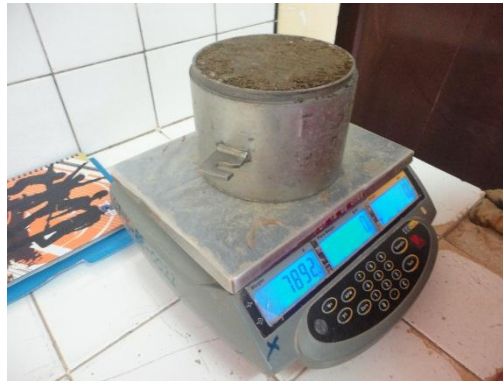
Figura 3. 21 Pesado de molde más la muestra
