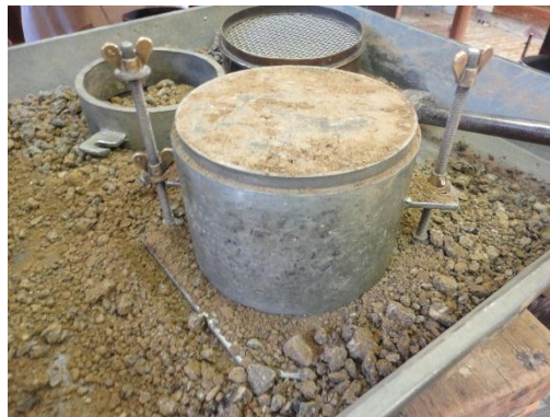
Figura 4. 12 Enrasado de material excedente del Proctor Fuente: Elaboración propia
