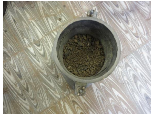
Figura 4. 10 Material para compactación Figura 4. 11 Primera capa de compactación Fuente: Elaboración propia
