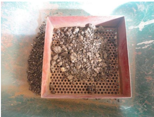
Figura 4. 13 Material pasante el tamiz 3/8" Figura 4. 14 Retenido el tamiz 1/4" Fuente: Elaboración propia
