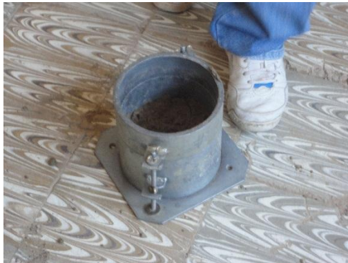
Figura 3. 19 Molde T-180 Proctor modificado Figura 3. 20 Proceso de compactado Fuente: Elaboración propia
