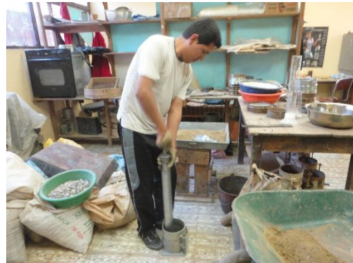
Figura 3. 19 Molde T-180 Proctor modificado Figura 3. 20 Proceso de compactado Fuente: Elaboración propia
