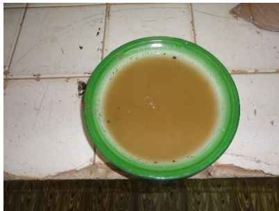
Figura 3. 11 Muestra para clasificación de suelo fino (método de lavado)
