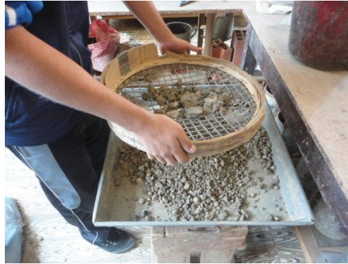
Figura 4. 7 Separando el material por la malla 3/4” Fuente: Elaboración propia
