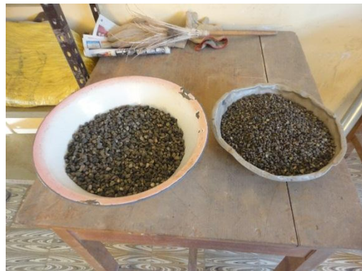
Figura 4. 15 Retenido en el tamiz N°4 Figura 4. 16 Retenido el tamiz 1/4" y N°4 Fuente: Elaboración propia
