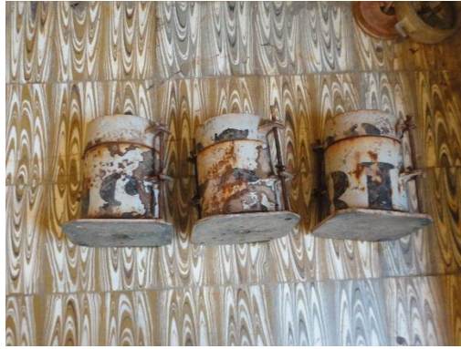
Figura 3. 24 Drenaje de agua moldes C.B.R Figura 3. 25 Lectura de cargas aplicadas Fuente: Elaboración propia
