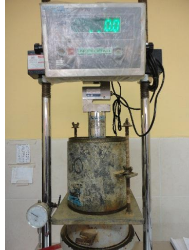
Figura 3. 24 Drenaje de agua moldes C.B.R Figura 3. 25 Lectura de cargas aplicadas Fuente: Elaboración propia
