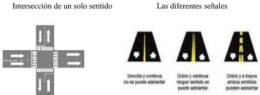
Fig. 2.33 Ejemplo de señalización horizontal
