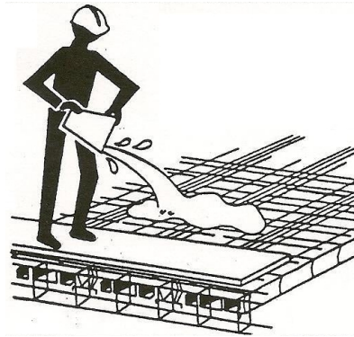
Figura 6: Hormigonado In Situ
