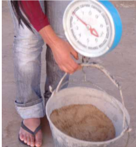
Figura 29: Peso de los agregados en balanza.
