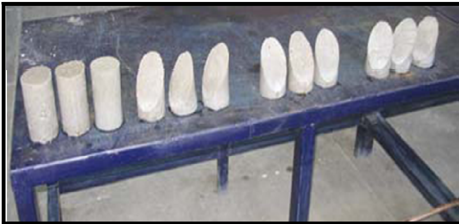
Figura N° 4.4.11. Testigo de probeta según Norma ASTM C-881-87 (Método estándar de la prueba para la fuerza de adherencia en los sistemas epoxicos a base de resina usados con concreto).
