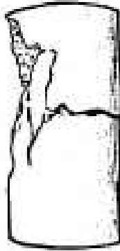
Figura N°2.9.9. Falla debido a un procedimiento de ensayo incorrecto
