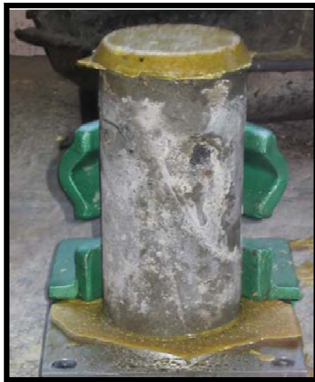
Figura N°4.4.12. Nivelación de probeta según Norma ASTM C-39-86 (Método estándar de prueba para fuerza compresiva de especímenes cilíndricos de hormigón).
