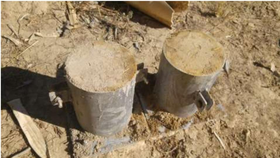
Fig.4.8 Probetas ya llenas
