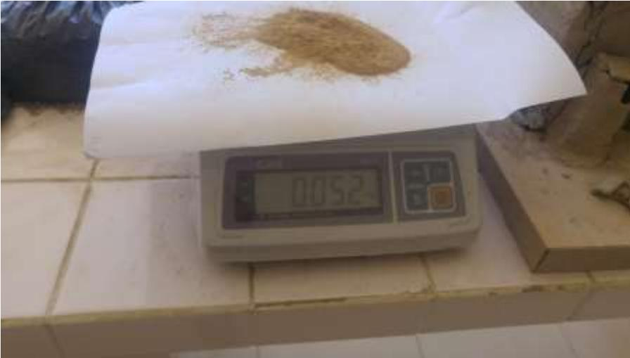
Fig.2.5 Balanza electrónica
