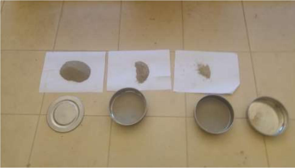
Fig.4 .Suelo arcilloso gris en diferentes tamices
