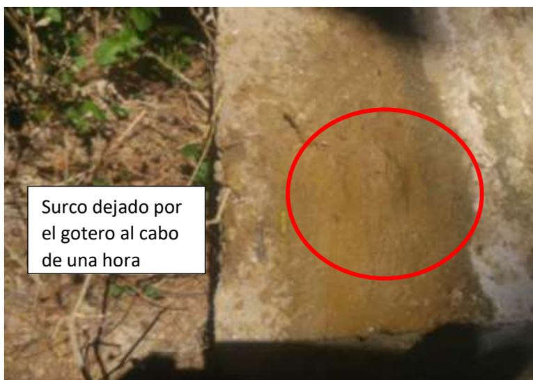
Fig 6.5 Tapial sometido a goteo
