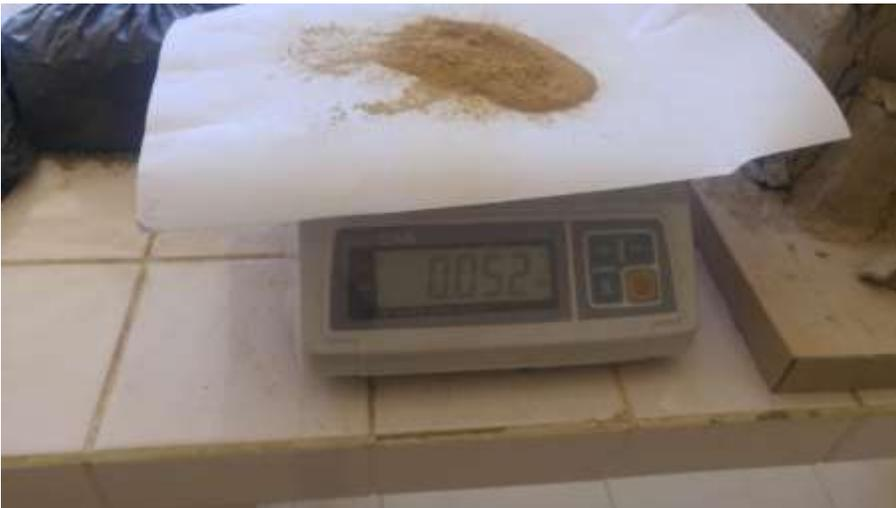
Fig.3.9 Pesando suelo arcilloso
