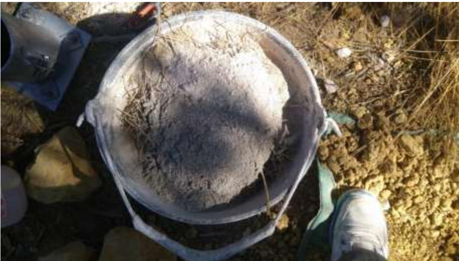
Fig.4.6 Mezcla de tapial en balde
