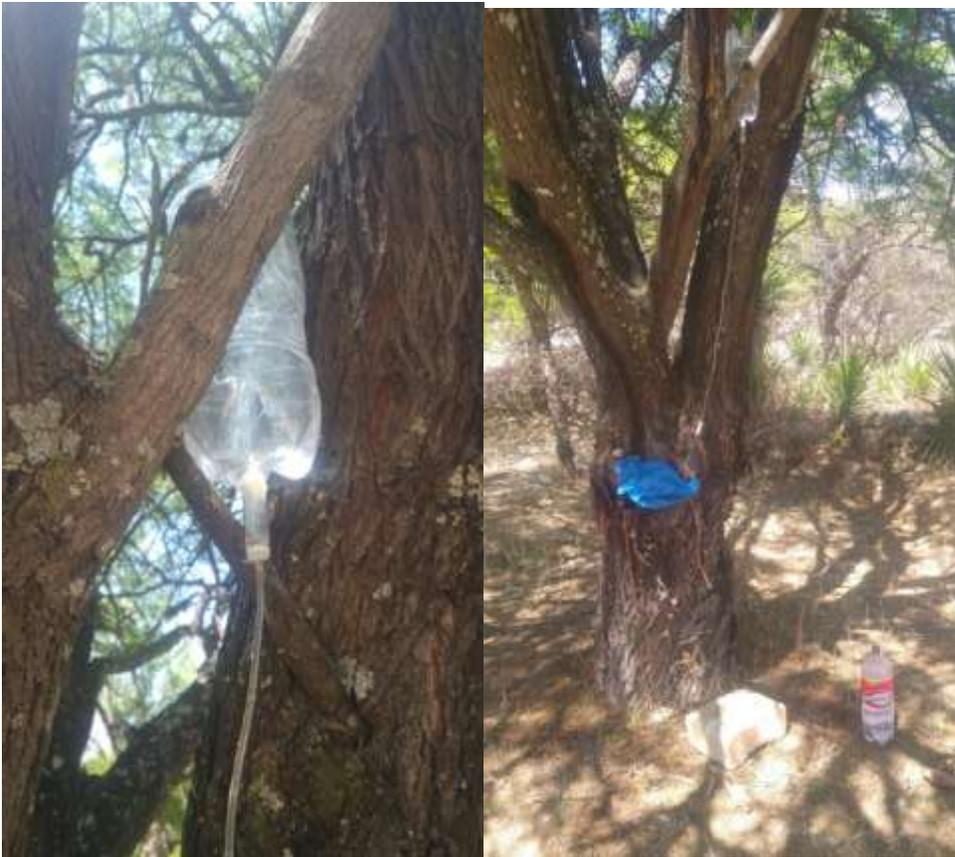
Fig 6 .4 Recipiente de agua elevado a 2 y a 1 metro el gotero de la muestra
