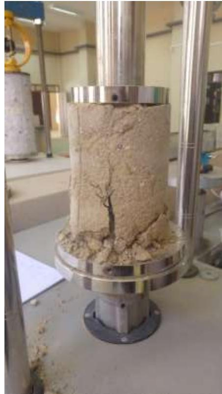
Fig 6 Probetas sometidas a esfuerzo de flexocompresion
