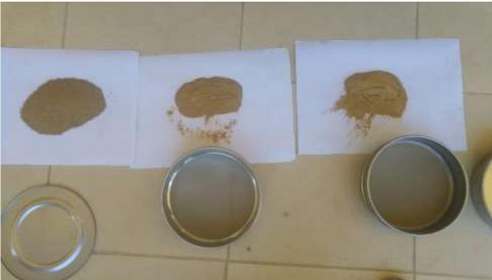
Fig.4.1 Suelo arcilloso amarillo en diferentes tamices
