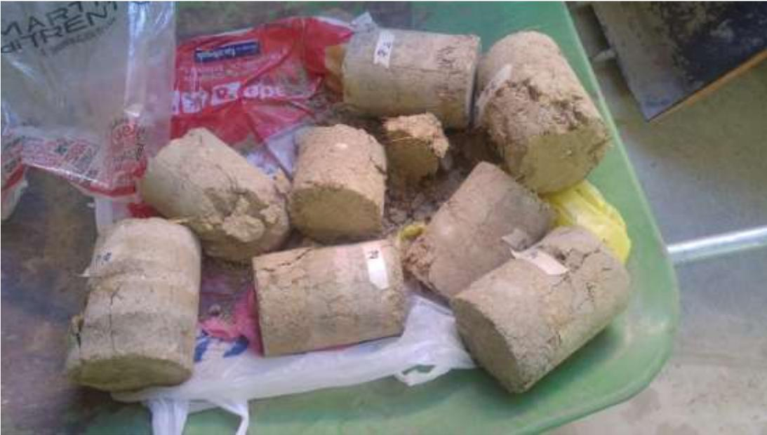
Fig 6.1 Probetas rotas en ensayo en laboratorio de suelo
