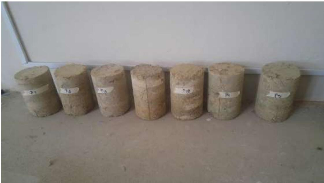
Fig.5 Probetas antes de flexocompresion
