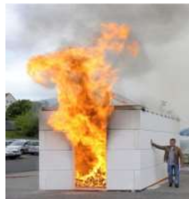
Pared Cortafuego después de fuego intenso
