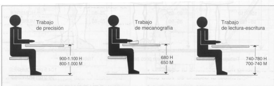
Altura del plano de trabajo para puestos de trabajo sentado (cotas en mm)
