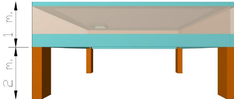
Fig. 3. 74 Altura del Tanque de Almacenamiento
