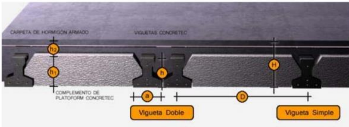
Cuadro 3. 23 Sistema de Aplicación de la Vigueta Pretensada
