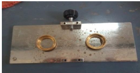
Imagen 3.33: Engrasado de los anillos y base para evitar que se pegue
