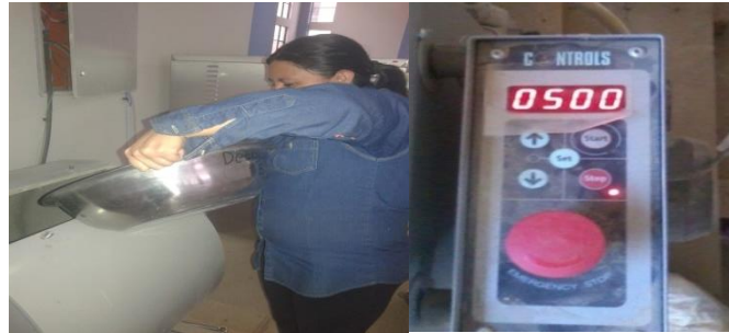
Imagen 3.21: Introducir la muestra y las cargas abrasivas En la máquina de los Ángeles
