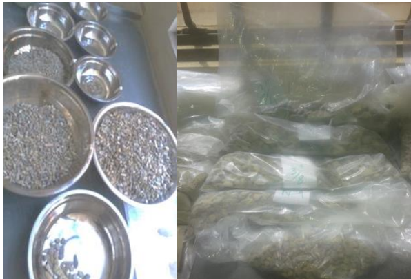
Imagen 3.50: Separación los agregados por tamaño para armar la granulometría
