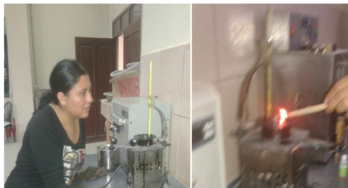
Imagen 3.32: Muestra en ensayo pasando la llama de fuego.
