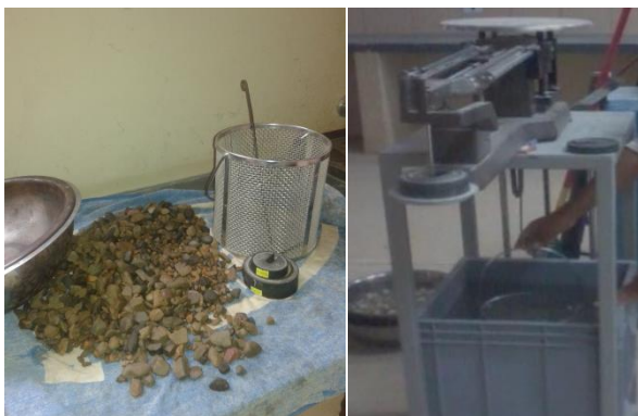
Imagen 3.5: Obtención del peso sumergido en agua.
