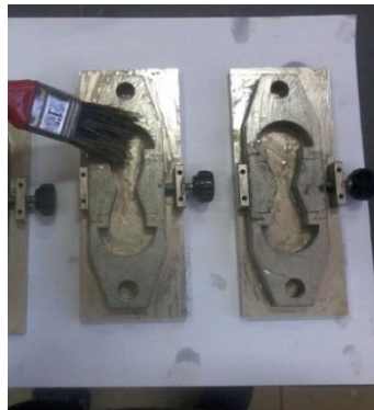
Imagen 3.28: Armado y engrasado de los platos de base y los moldes
