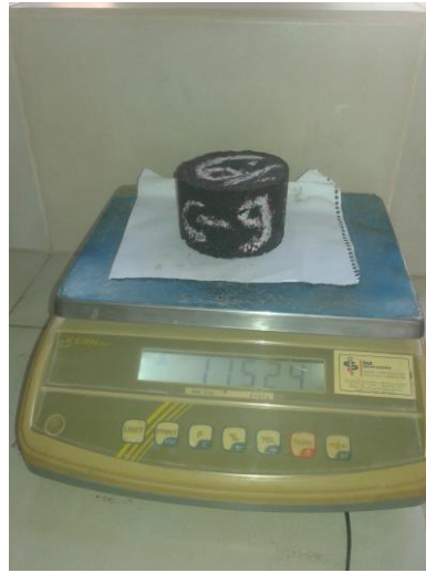
Imagen 3.56: Pesar las briquetas saturadas con superficie seca.
