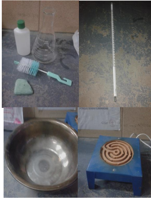
Imagen 3.41: Materiales a ser utilizados para la Calibración del frasco volumétrico
