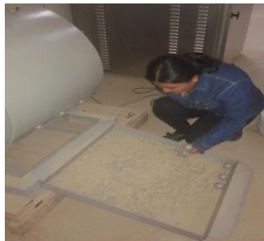
Imagen 3.22: Sacar el material y las cargas abrasivas
