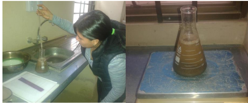
Imagen 3.11: Colocar en un matraz 500gr de material, llenar agua y pesa
