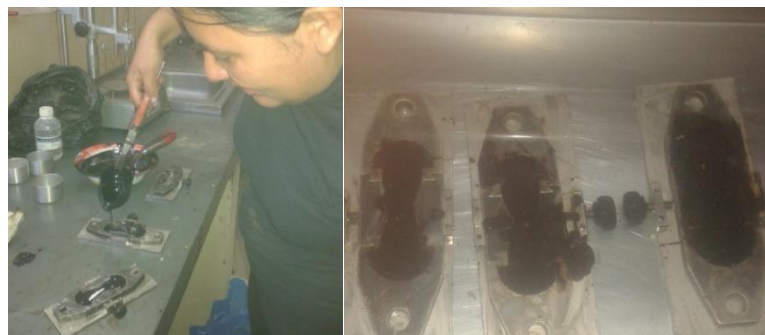
Imagen 3.29: Verter el cemento asfáltico en los moldes y dejar enfriar Después poner en baño maría
