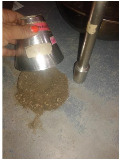
Imagen 3.10: Verificación de la condición muestra Saturada con superficie seca.
