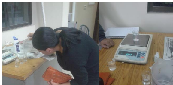
Imagen 3.38: Calibrar y luego pesar cada uno de los picnómetros
