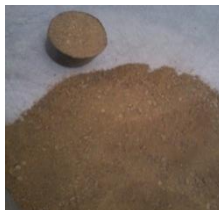
Imagen 3.14: Seleccionar material que pase el tamiz N° 4
