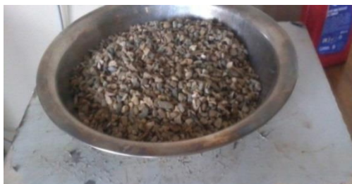
Imagen 3.4: Peso del material superficialmente seco
