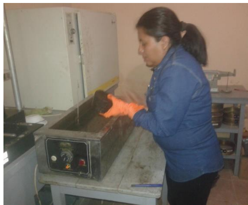
Imagen 3.57: Poner en baño María a 60°C por 35 min para cada una
