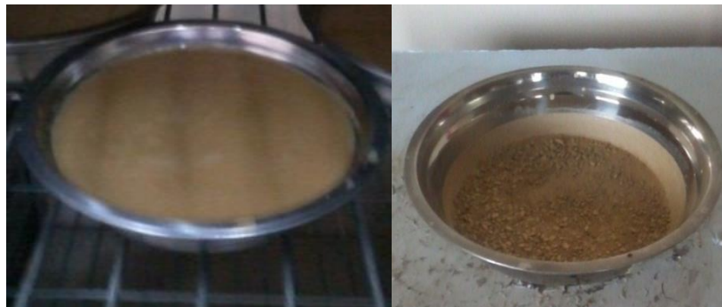
Imagen 3.12: Sacar la muestra del matraz y dejar secar en el horno para posteriormente pesar
