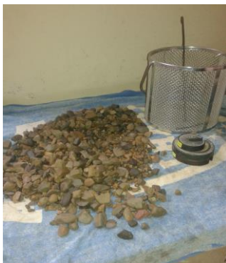
Imagen 3.3: Secado superficial de la muestra saturada en agua.
