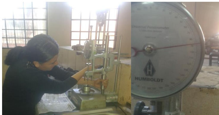
Imagen 3.27: Realizar el ensayo teniendo en cuenta que este limpia la aguja.
