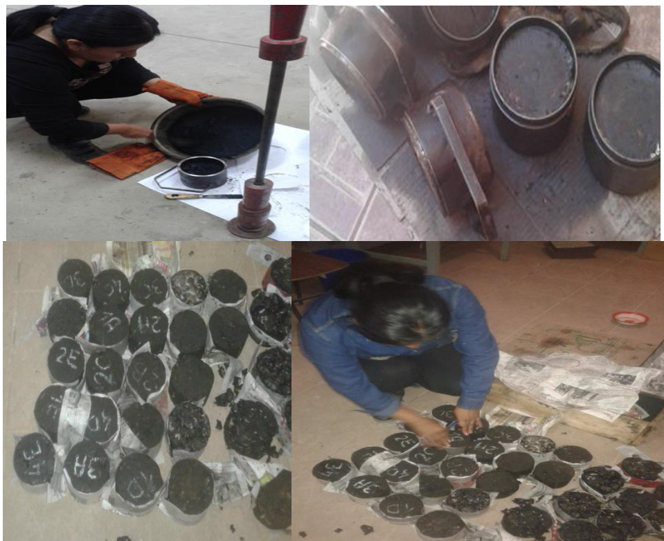
Imagen 3.53: Compactar con 75 golpes cada lado, desmoldar y dejar enfriar
