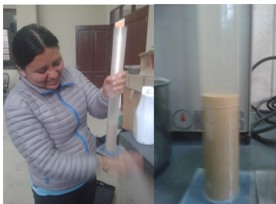
Imagen 3.16: Colocar el material y golpear en la parte baja del cilindro Para evitar burbujas de aire y dejar reposar por 10 minutos
