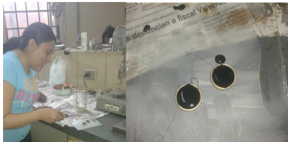
Imagen 3.34: Verter el cemento asfáltico en los anillos y dejar enfriar
