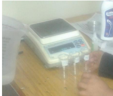
Imagen 3.37: Peso de los picnómetros vacíos
