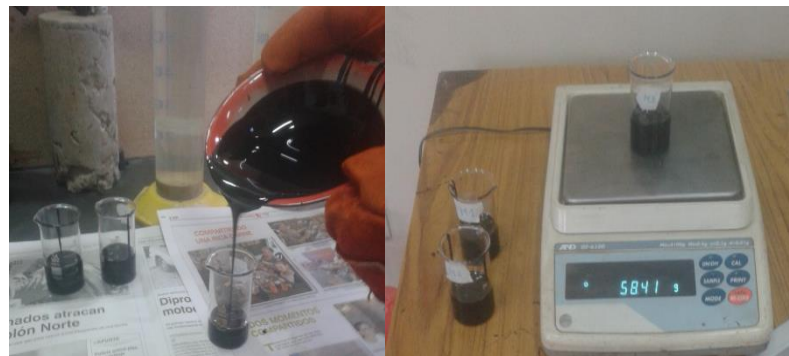
Imagen 3.39: Verter el cemento asfáltico en los picnómetros
