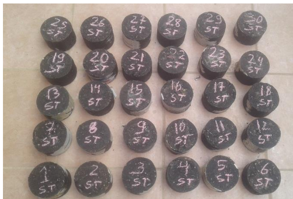
Figura 4.5 Briquetas elaboradas con el contenido óptimo de C.A. (5.69%)
