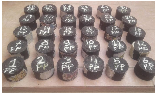
Figura N°4.4 Briquetas elaboradas con el contenido óptimo de C.A. (5.75%)
