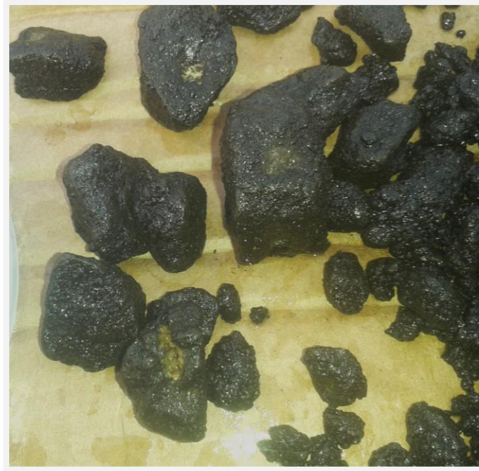
Figura 52. Ensayo de desprendimiento por fricción en mezclas asfálticas con agregados ácidos.
