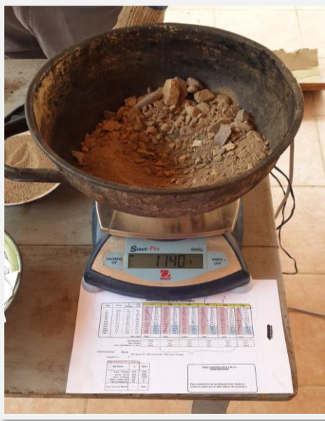
Figura 25. Pesado de los agregados pétreos alcalinos para el diseño de la mezcla asfáltica.
