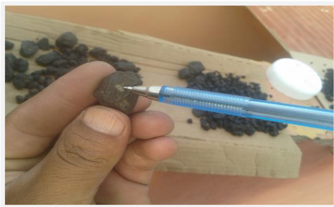
Figura 40. Evaluación del desprendimiento agregado pétreo – asfalto.
