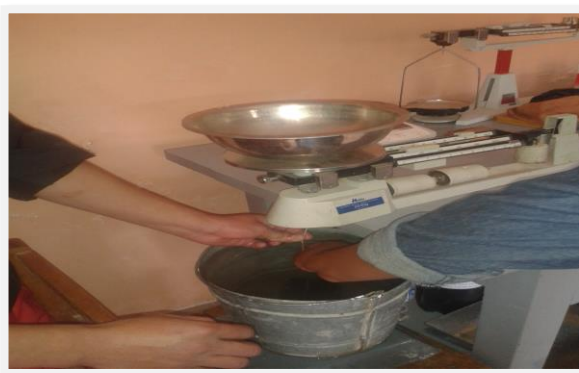
Figura 31. Determinación del peso sumergido de la briqueta.
