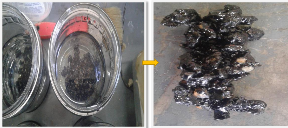
Figura 44. Estimación visual del desprendimiento ocasionado por el fenómeno de Stripping, método AASHTO T-182.
