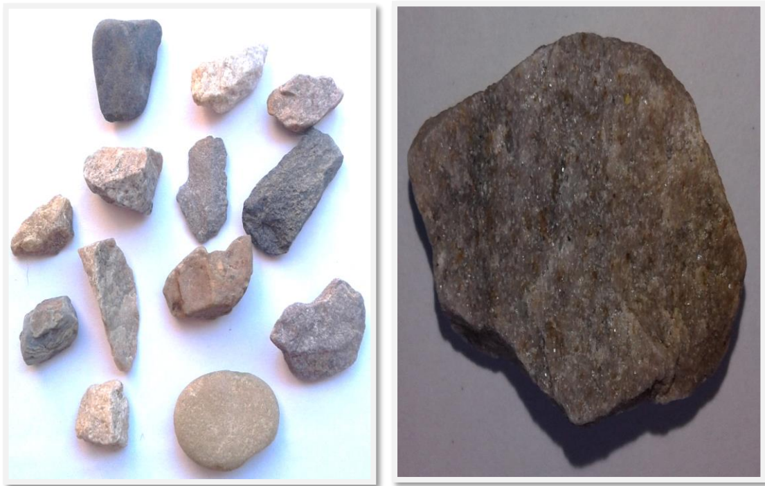
Figura 20. Agregado alcalino procedente del banco de áridos San José de Charaja.
