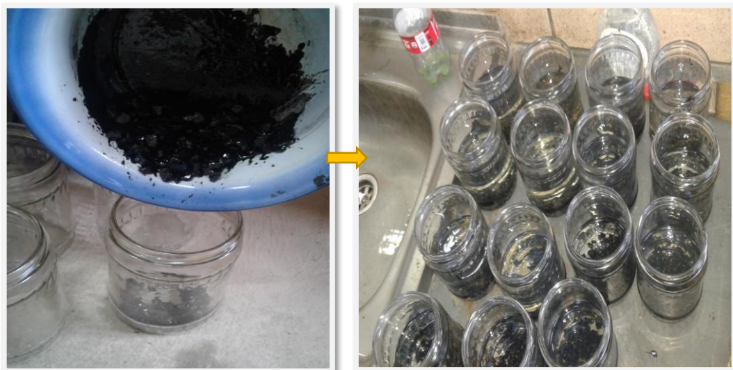
Figura 43. Vaciado de la mezcla asfáltica en recipientes y sometidos a saturación en agua destilada, método AASHTO T-182.
