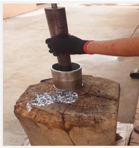
Figura 27. Compactación de la mezcla asfáltica según metodología Marshall.
