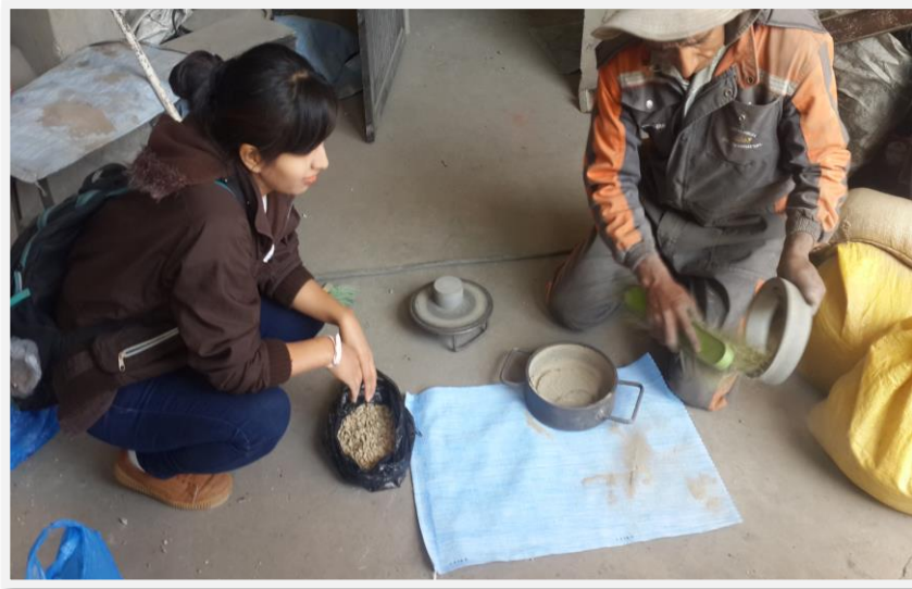
Figura 17. Molienda de las muestras de Grava 3/8", 3/4" y arena en la empresa minera GCAL "Ch'asquita" SRL.
