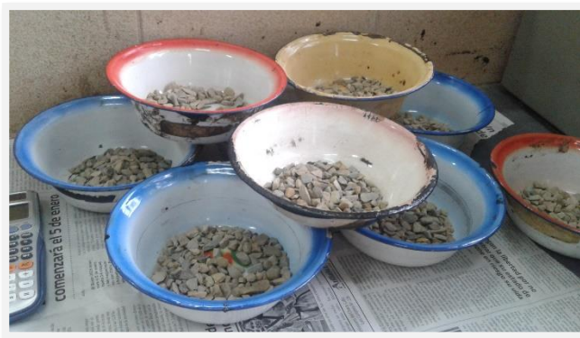
Figura 41. Pesado de los agregados pétreos para el ensayo de adherencia AASHTO T-182.
