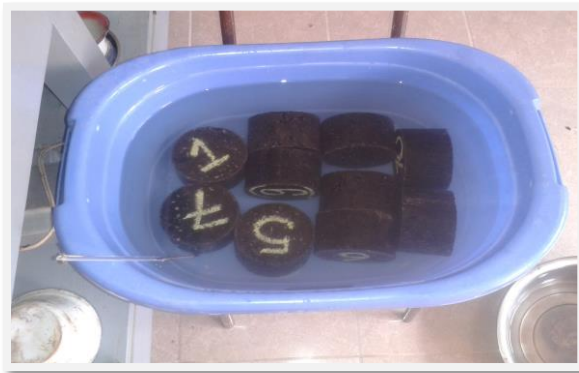
Figura 30. Determinación del peso saturado superficialmente seco de la briqueta.
