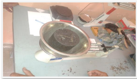
Figura 29. Determinación del peso seco de la briqueta.
