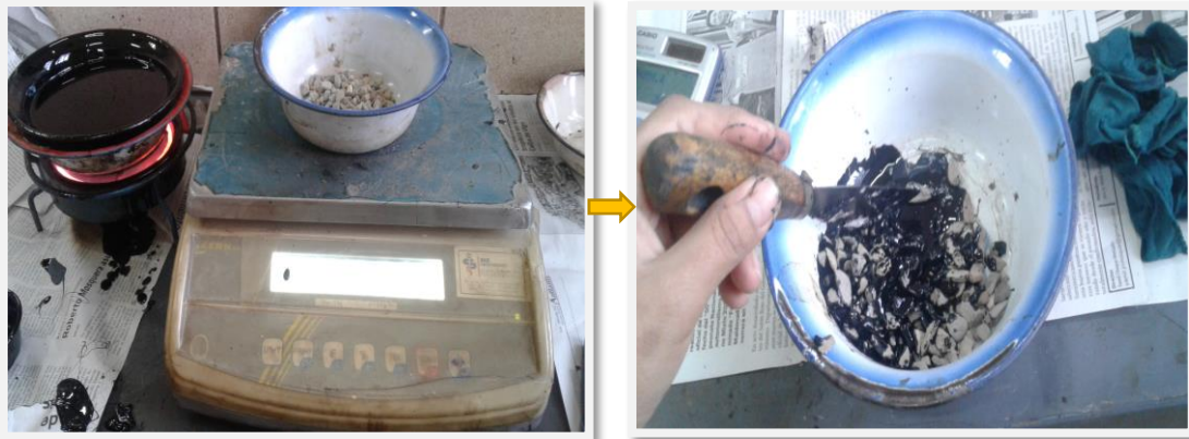
Figura 42. Mezclado de agregado – asfalto para el ensayo de adherencia AASHTO T-182.
