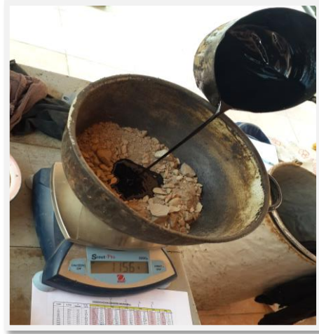
Figura 26. Adición de cemento asfáltico 85-100 para el diseño de la mezcla asfáltica.
