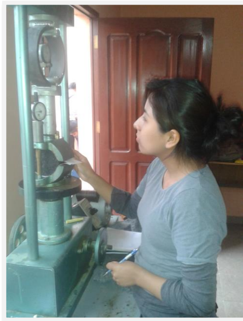
Figura 32. Determinación de la estabilidad y flujo de las briquetas en la prensa Marshall.
