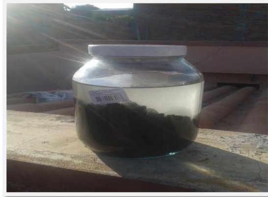
Figura 39. Ensayo de desprendimiento por fricción norma N-CMT-4-04 materiales pétreos para mezclas asfálticas.
