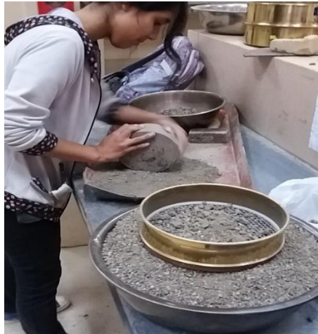
Figura N° 3.7. Molido y tamizado del suelo.
