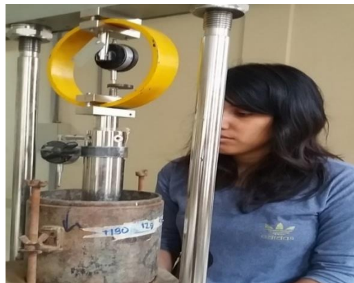
Figura N° 3.9. Toma de lecturas de carga.
